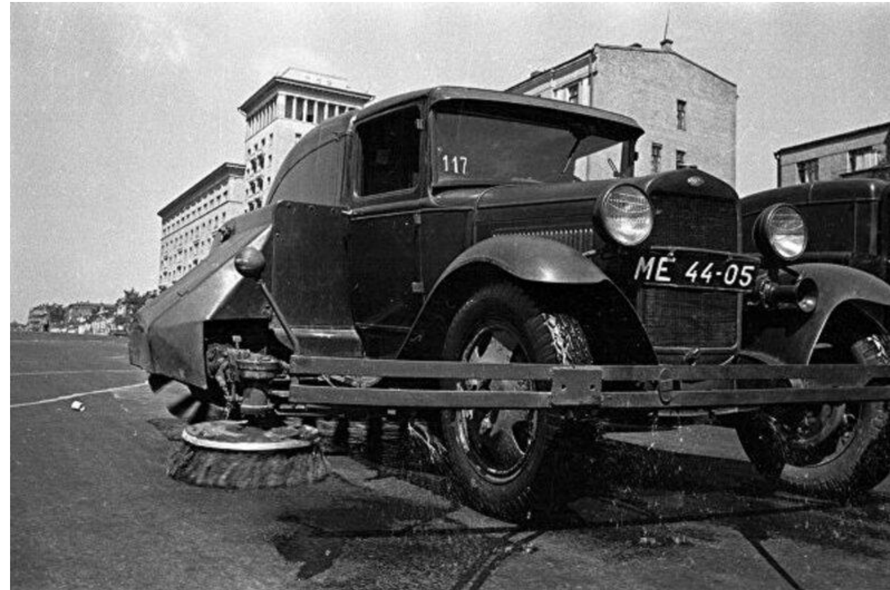
Первая советская подметальная машина ПУ-2 на шасси ГАЗ-АА на Садовом кольце. 1936 год
