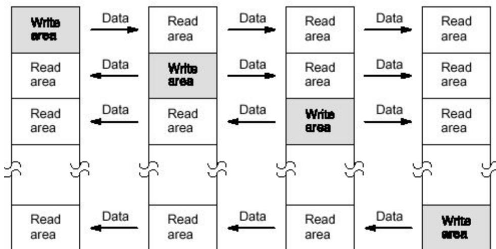
Область LR используется в качестве области общих данных для передачи информации между ПЛК в системе PC LINC.
