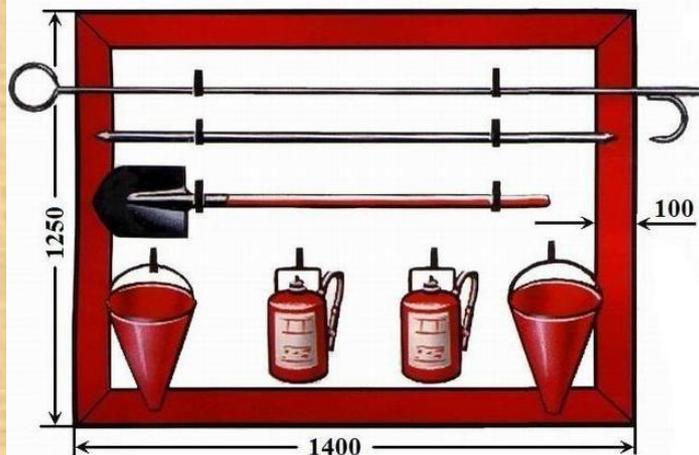
**ПРЕДНАЗНАЧЕН** для размещения первичных средств пожаротушения, немеханизированного инструмента и пожарного инвентаря в производственных и складских помещениях, не оборудованных противопожарным водопроводом и автоматическими установками пожаротушения, а также на территории предприятий, не имеющих наружного противопожарного водопровода, или при удалении зданий (сооружений), наружных технологических установок на расстояние более 100 м от наружных пожарных водосточников.
