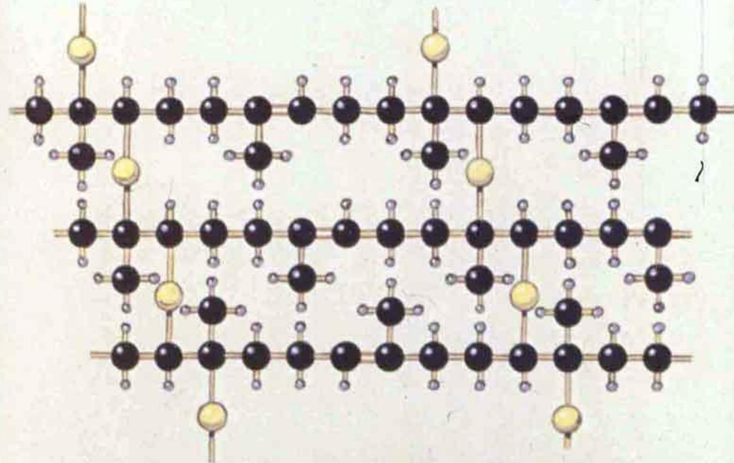
При вулканизации между полимерными цепями возникают новые поперечные связи—дисульфидные мостики. «Нитевидные» молекулы каучука «сшиваются» атомами серы — получается резина.
