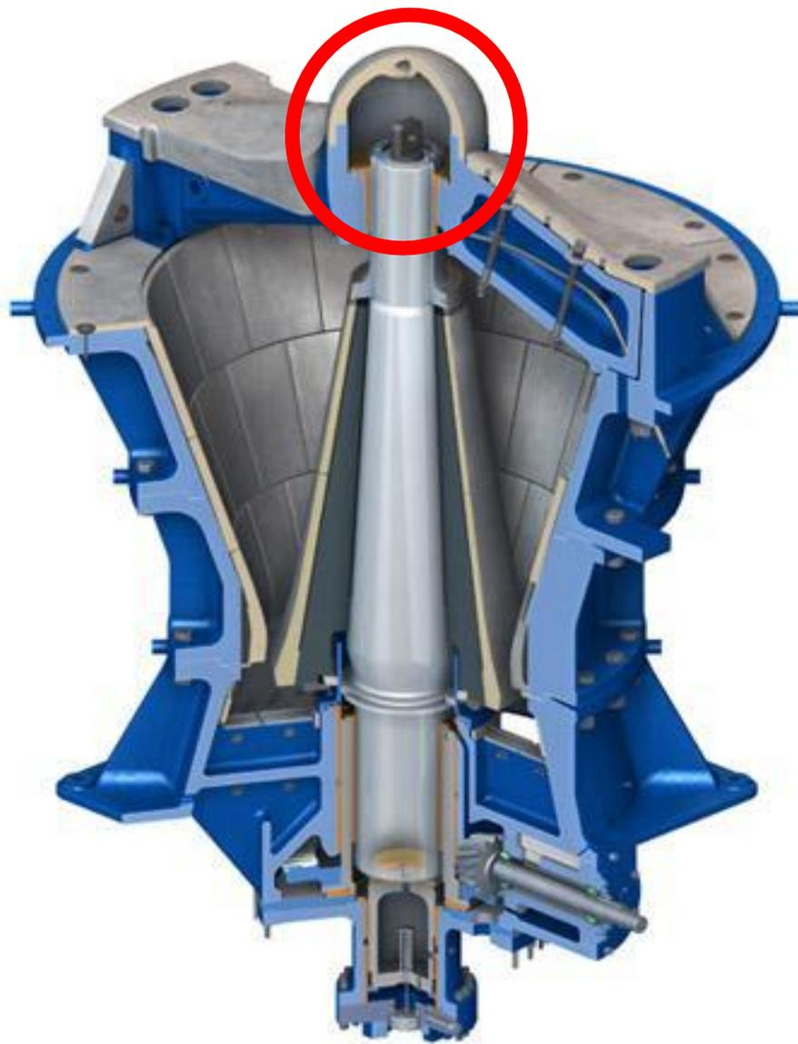
Дробилка оборудована гидравлической системой регулировки, регулирующей положение и обеспечивающей опору главного вала.
