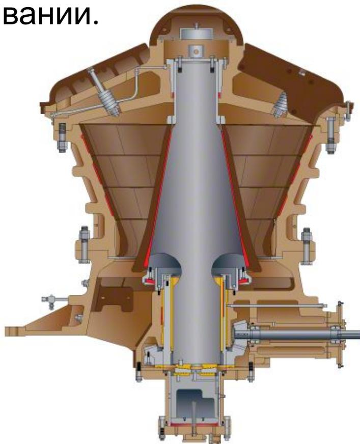
Не рекомендуется эксплуатация дробилки при высоте конуса менее чем 50 мм от крайнего нижнего положения, так как необходимо обеспечить место для хода конуса.
