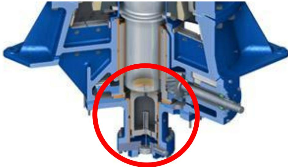
Подвижный конус поднимается или опускается, регулируя ширину разгрузочной щели либо для изменения размера готовой фракции, либо для очистки дробилки.
