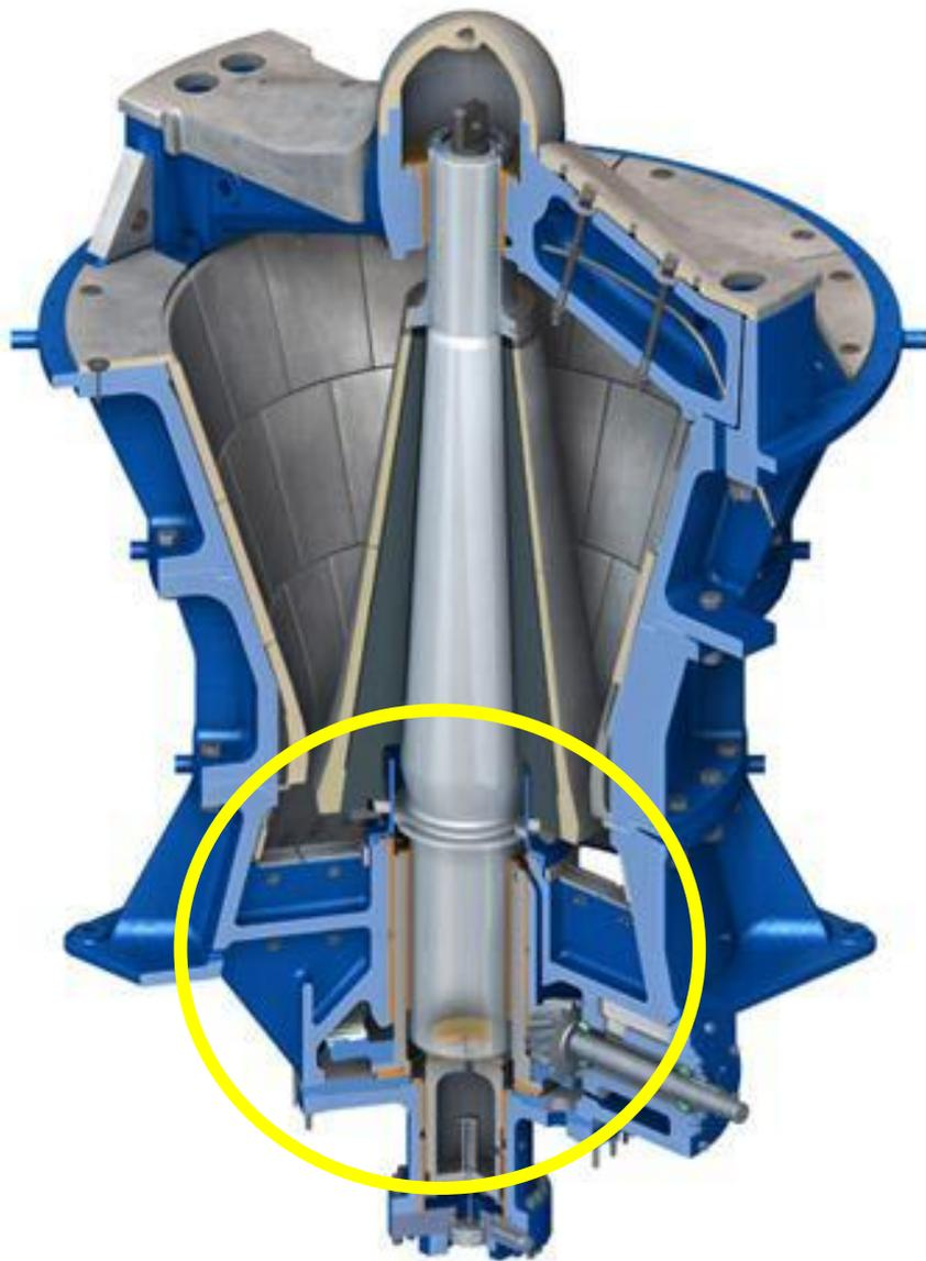
Жираторная дробилка оснащена системой циркуляции смазки, подающей фильтрованное и охлажденное масло для смазки втулок и шестерен эксцентрикового привода дробилки.
