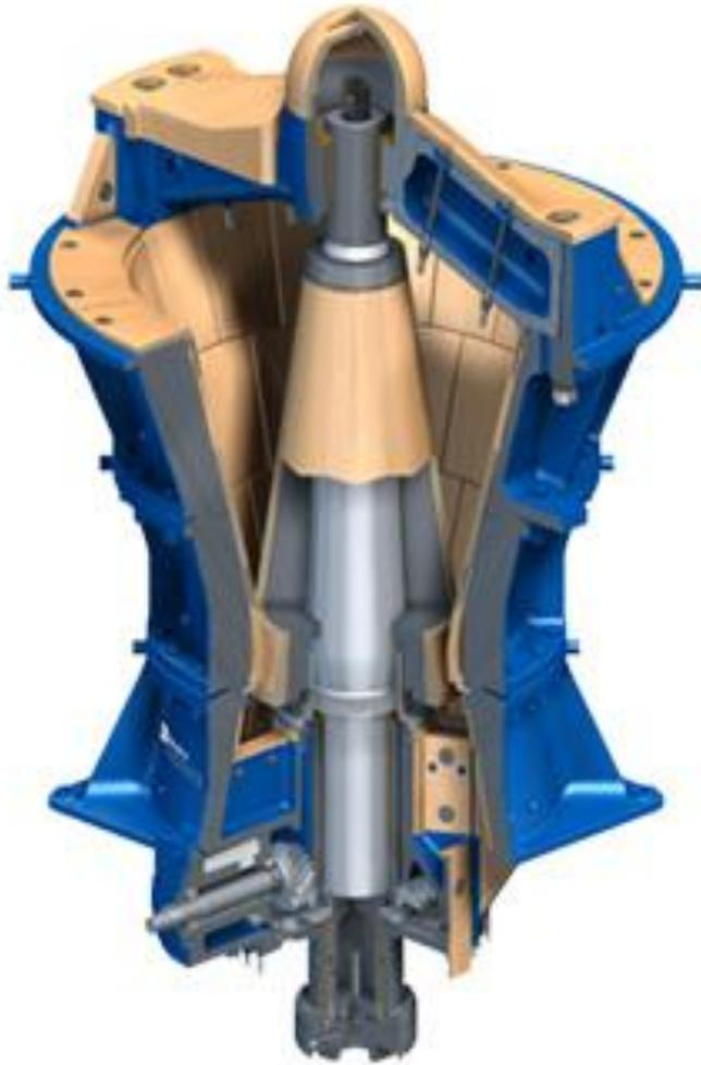
Жираторная дробилка состоит из литого корпуса, в нижней части которого заключен приводной механизм.
