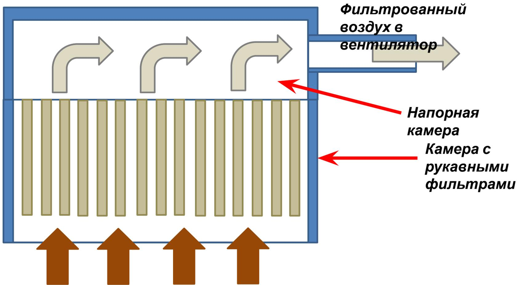
Воздух втягивается через стенки рукавных фильтров, проходит через напорную камеру и попадает в вентилятор, откуда в конечном итоге выходит в атмосферу.
