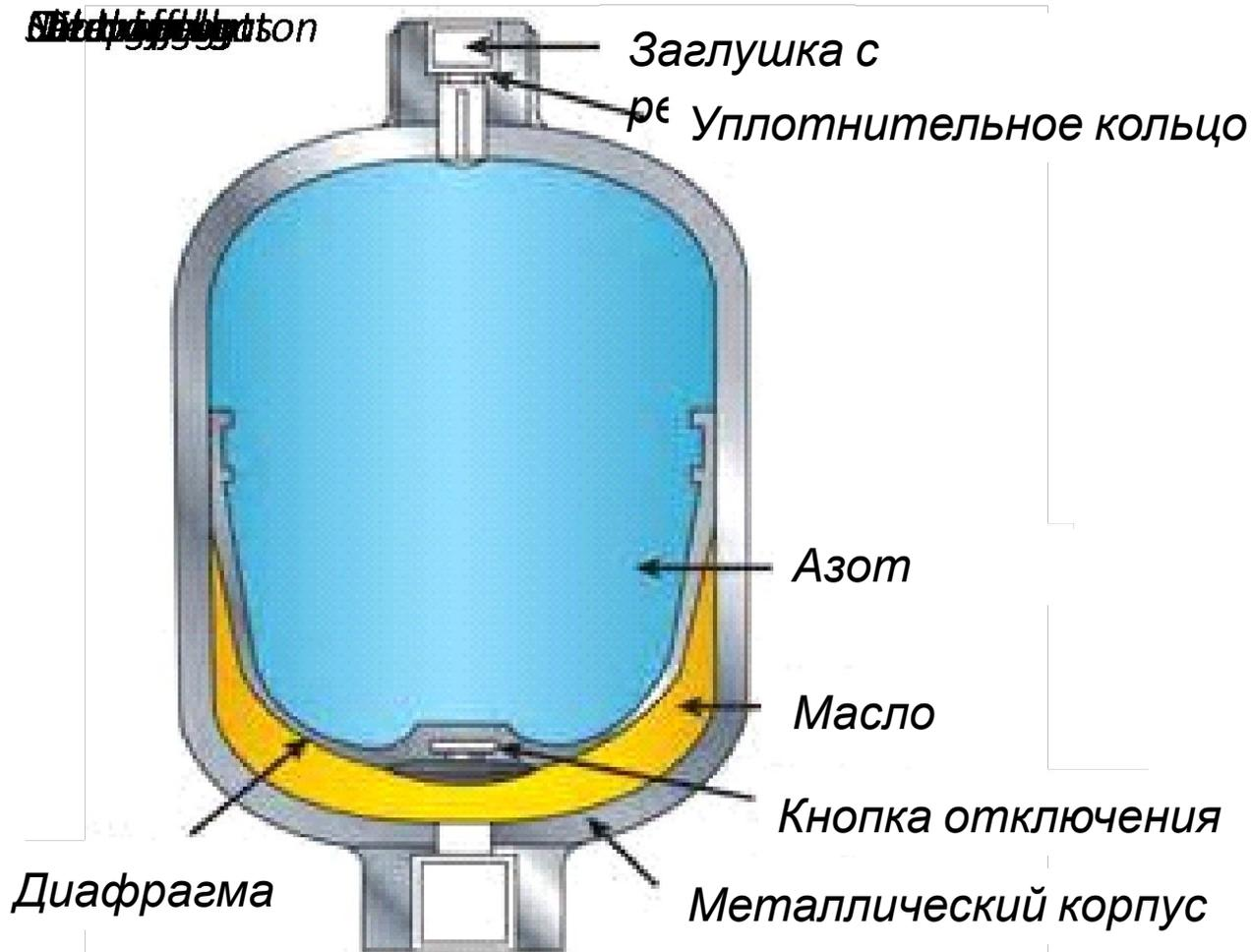
Аккумулятор предварительно заряжен азотом до значения давления, которое допускает сжатие азота до определенной степени, когда вес конуса повышает давление масла на другой стороне плунжера.
