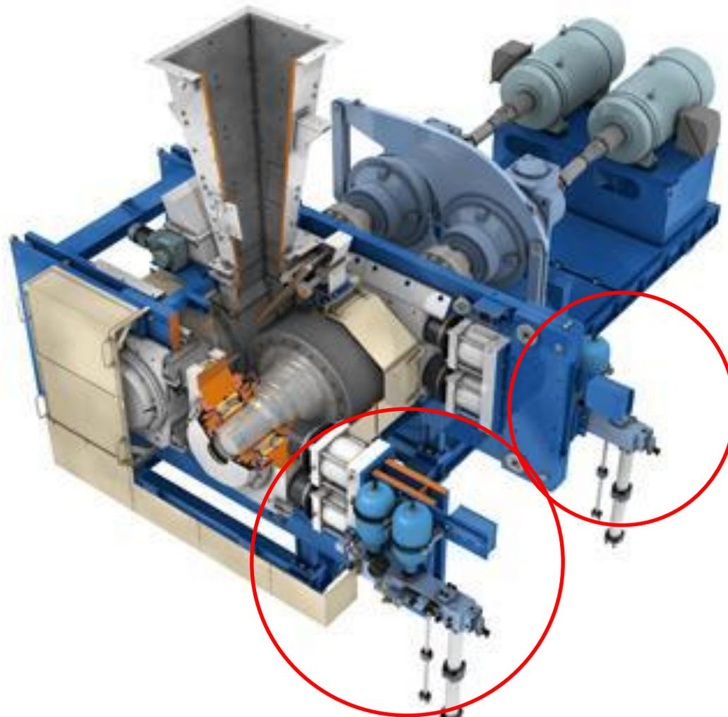
Плавающий валок приводится в действие системой сброса давления, обеспечивающей движение плавающего валка и возможность прохождения недробимых материалов. После выхода недробимого материала плавающий валок автоматически возвращается в исходное положение.
