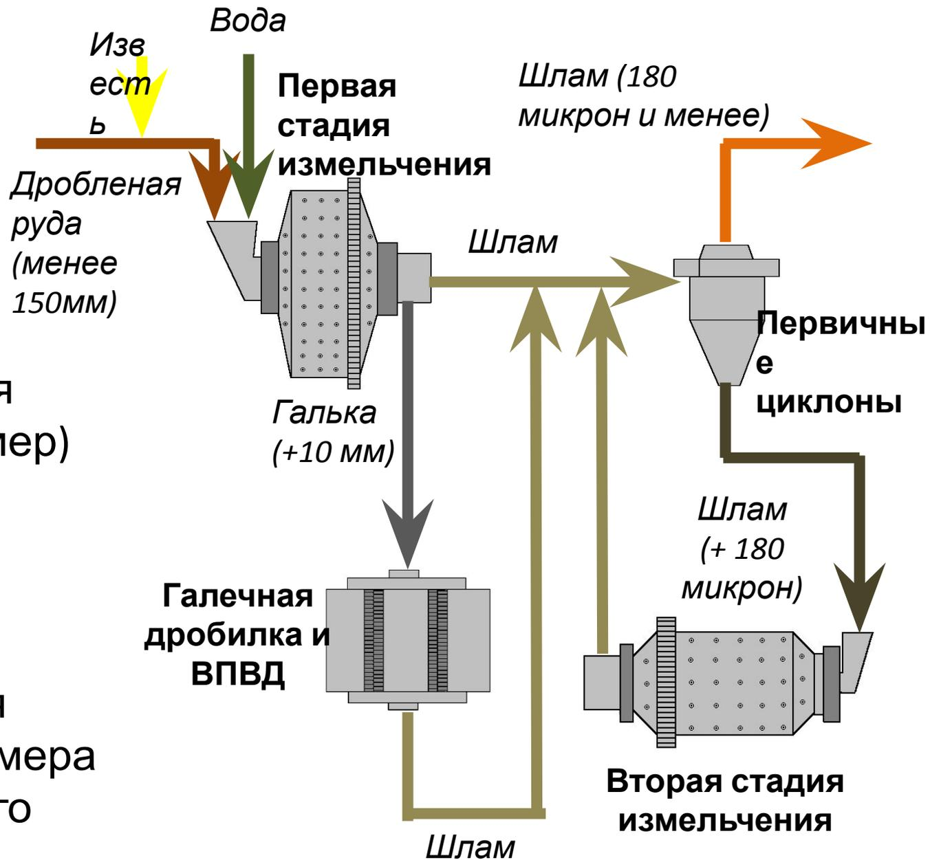
Крупная фракция (микронный размер) первой стадии измельчения проходит через вторую стадию измельчения для уменьшения размера частиц до нужного размера.
