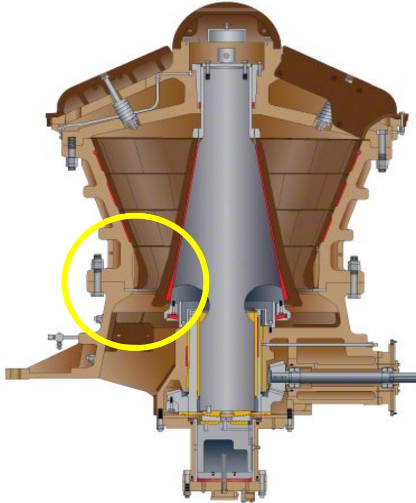
По мере опускания подвижного конуса расстояние между конусом и броней корпуса дробилки увеличивается, что в свою очередь увеличивает размер готовой фракции.
