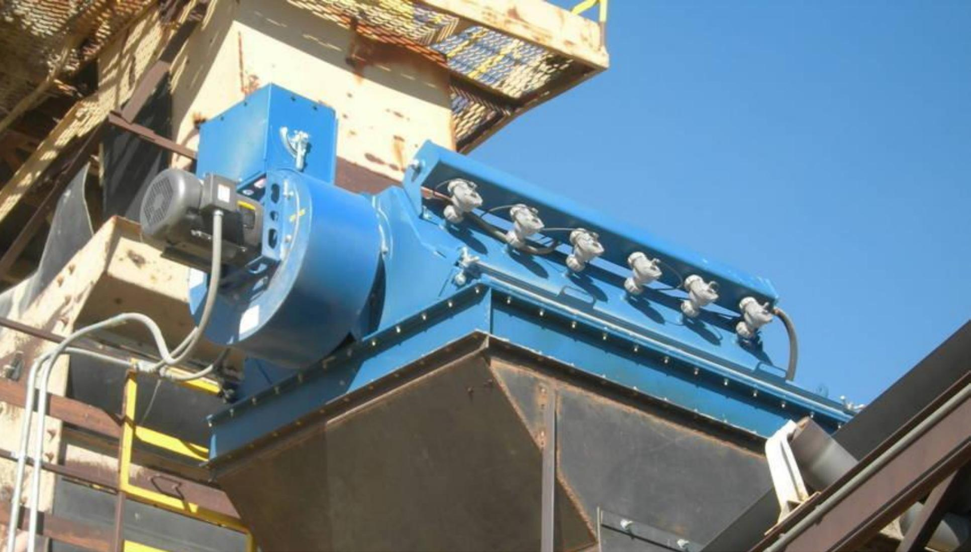
Для улавливания выделяемой пыли используются реверсивные импульсные пылеуловители. Они как правило устанавливаются над разгрузочным желобом конвейера или пластинчатого питателя.
