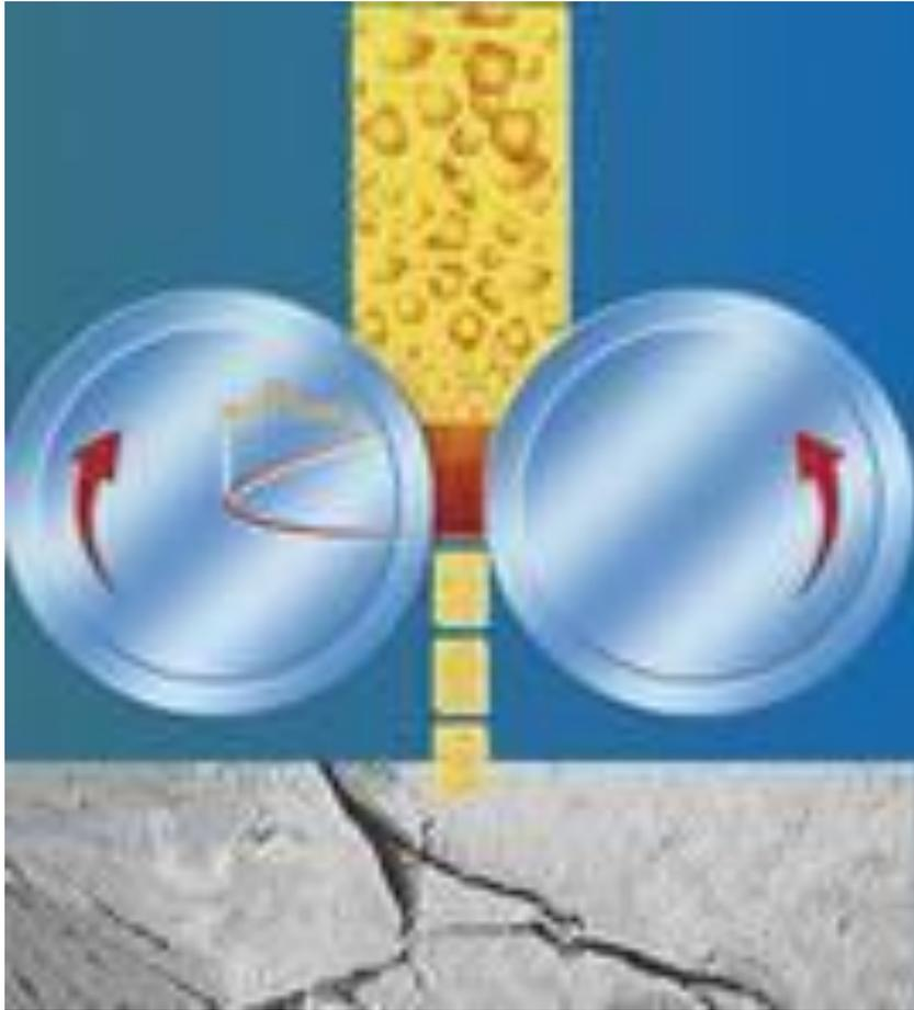
Во время работы материал попадает в зазор между валками за счет вращающегося движения и трения, создаваемого между валками и частицами материала.
