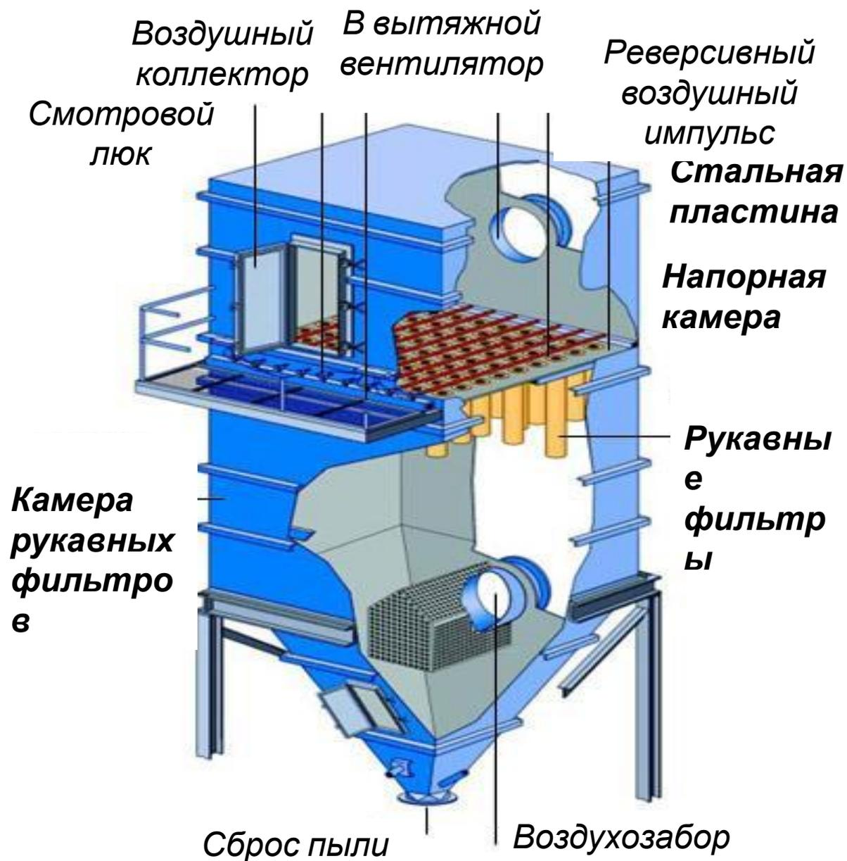
Рукавные фильтры (иногда называемые "носками") изготовлены из плетеного синтетического фильтрующего волокна. Плетение обеспечивает прохождение воздуха, не пропуская твердые частицы.
