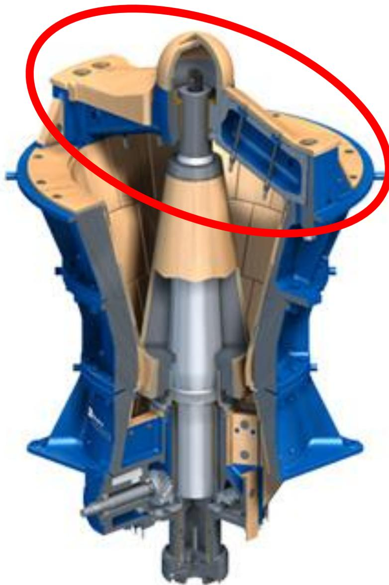
Лапа траверсы проходят поперек загрузочной щели. Они закрыты тяжелой броней.
