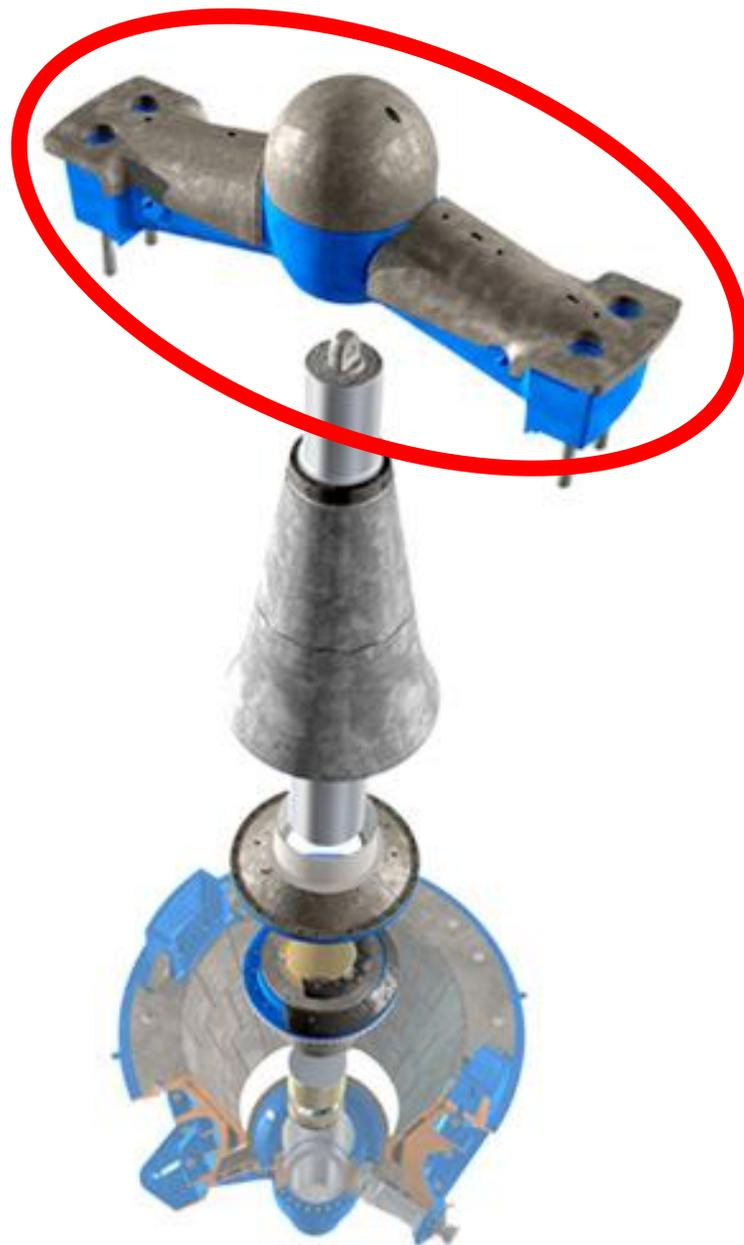
В узле траверсы предусмотрена выточенная опора, которая регулирует положение верхнего конца главного вала и предотвращает его поперечное смещение.
