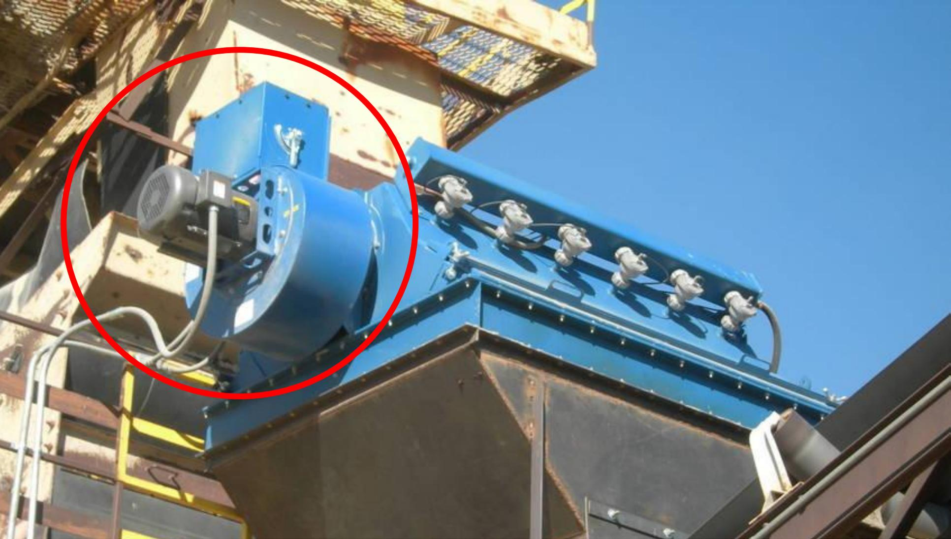
С наружной стороны пылеуловителя установлен вытяжной вентилятор, приводимый в действие электродвигателем. Именно вытяжной пылеулавливающий вентилятор создает отрицательное давление или разрежение, необходимое для
