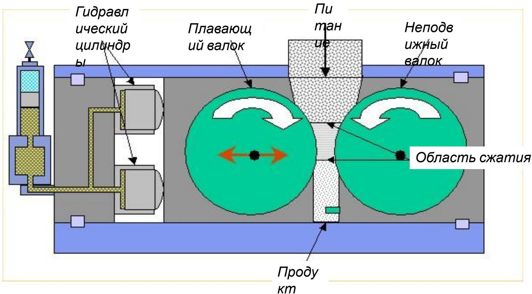
Измельчающая сила передается на *плавающий валок* посредством гидравлических цилиндров. Размер продукта зависит от ширины зазора между валками.
