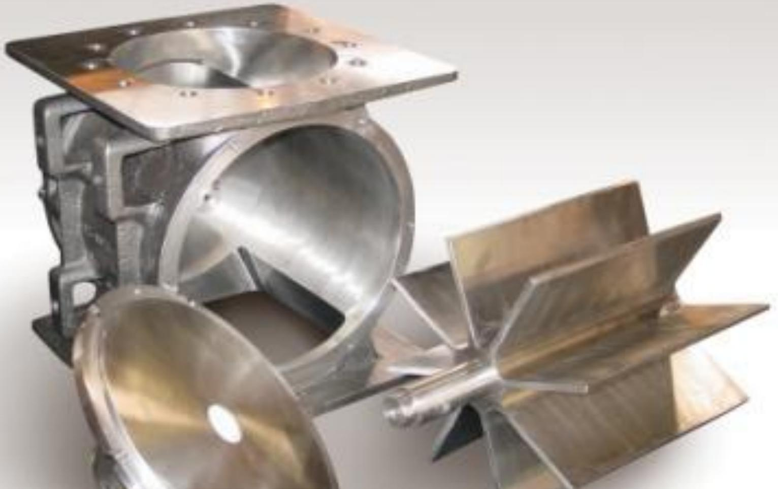
Ротор дозатора состоит из главного приводного вала и группы лопаток. Пространство между лопатками образует карман, который захватывает, перемещает и выгружает материал.
