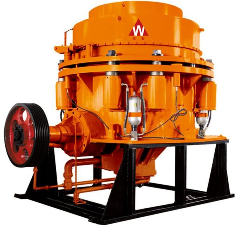
В конусной дробилке материал дробится между двигающимся взад-вперед конусом и неподвижной изогнутой чашей. Основными компонентами дробилки являются главная рама, узел чаши, узел главного вала и приводная
