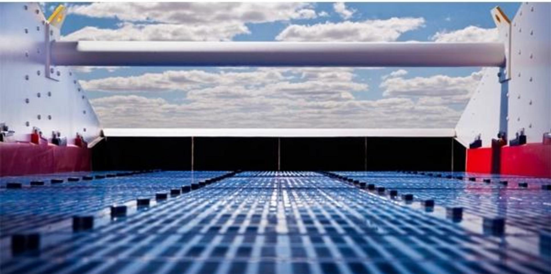
Сита грохота выполнены в виде съемных полиуретановых панелей с отверстиями, устанавливаемых на брусья, покрытые резиной. В двухдечном грохоте верхнее (*обдирочное*) сито имеет отверстия большего диаметра, чем нижнее сито.
