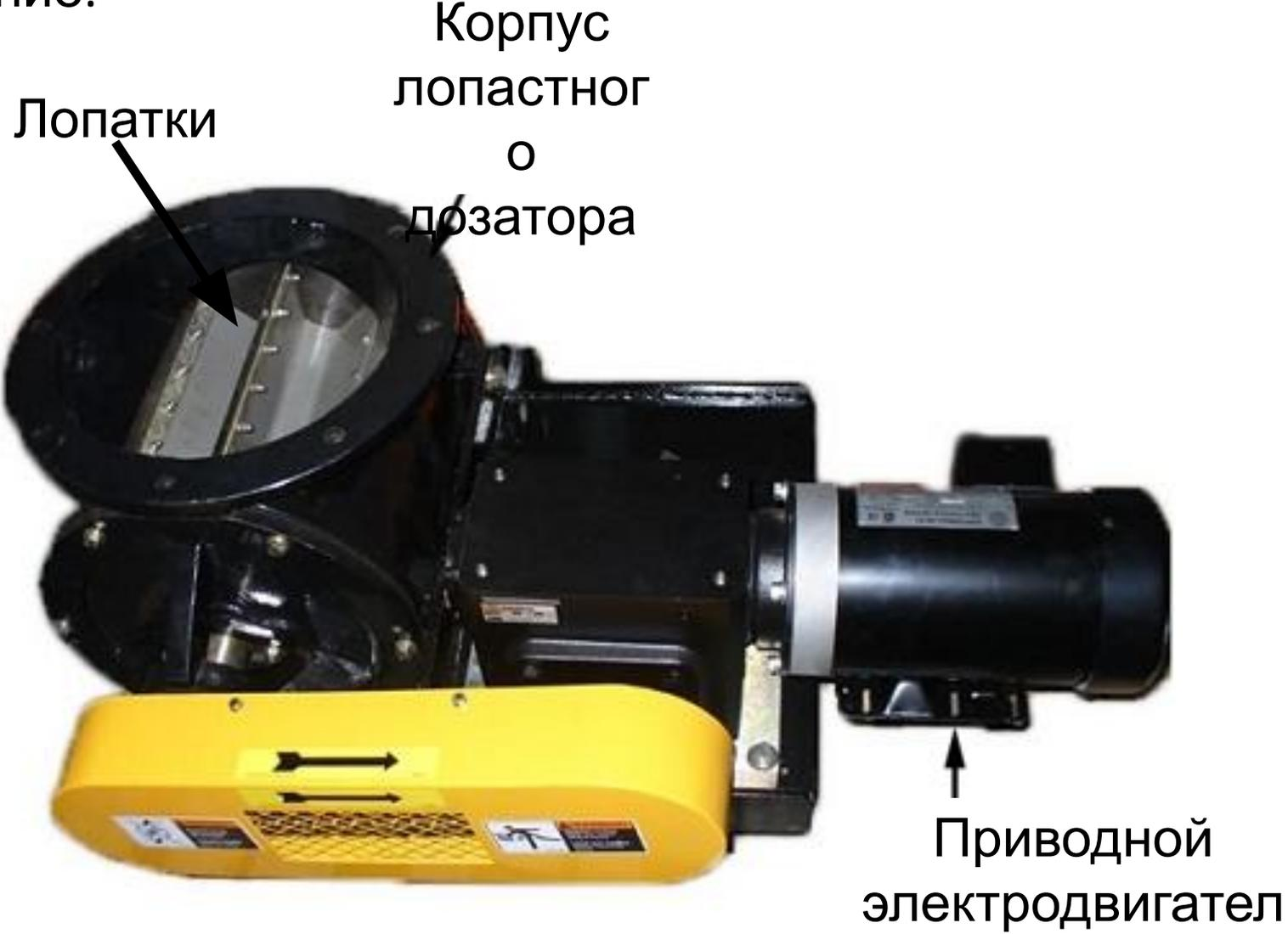
По мере вращения ротора дозатора каждый карман, достигая верхней точки, заполняется материалом. Под действием силы тяжести материал падает внутрь через верхнее отверстие в корпусе.
