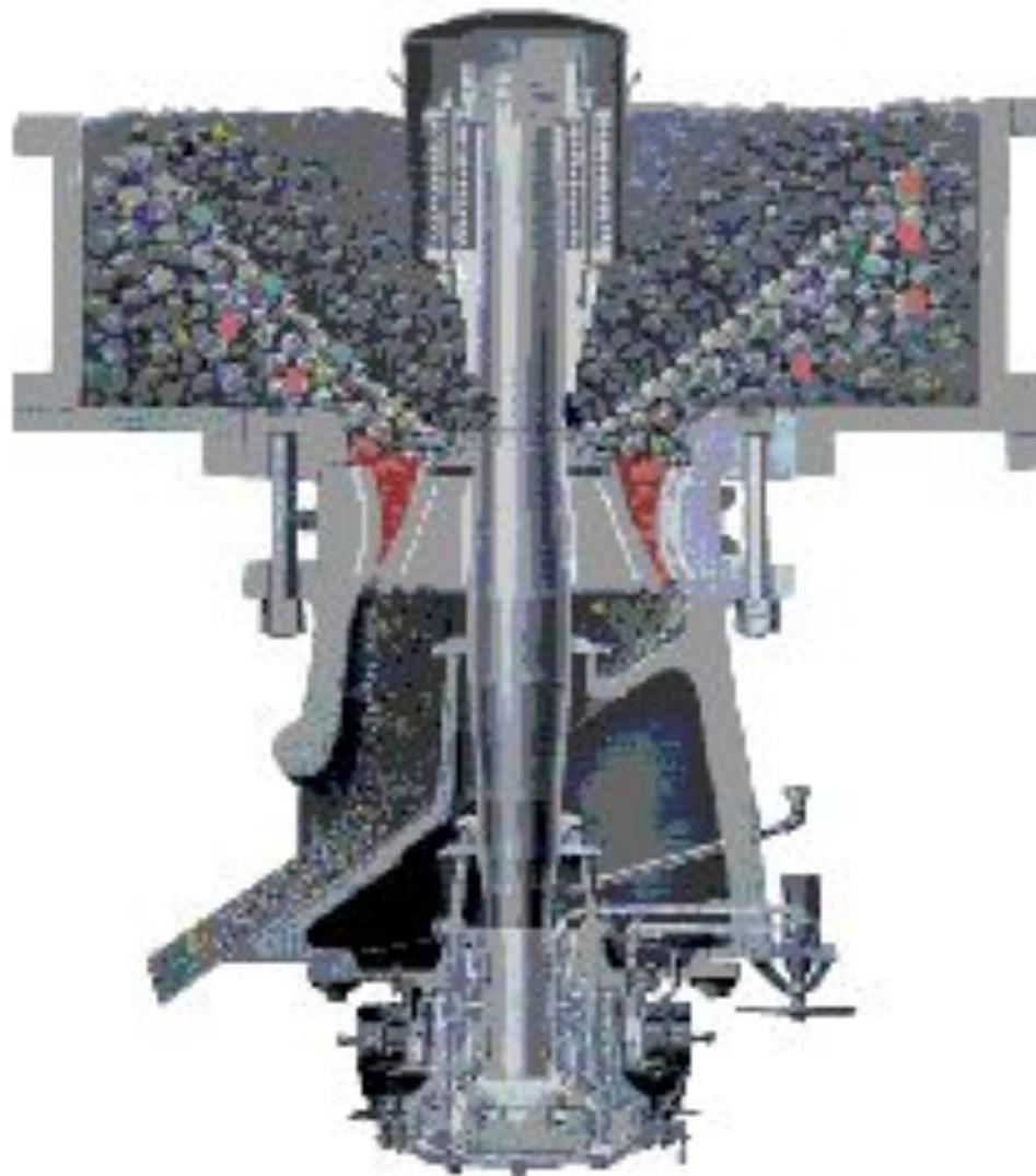
Главный вал дробилки проходит вертикально через корпус дробилки.
