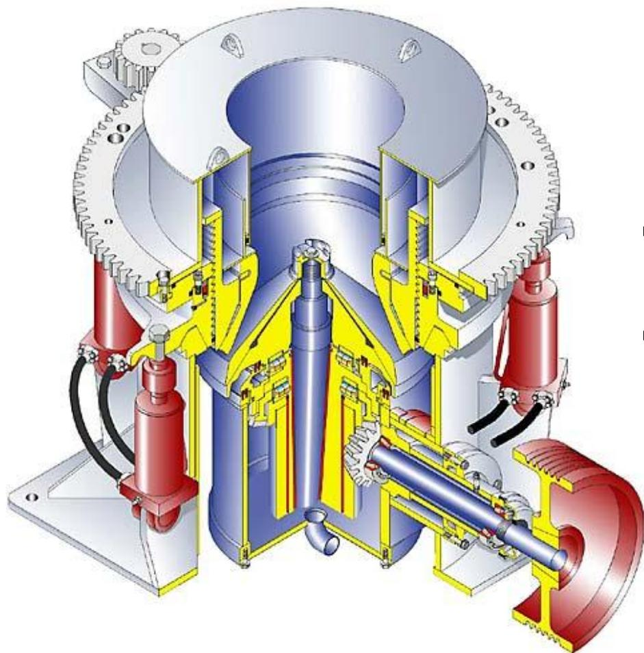
зедмета. После того, как посторонний металлический предмет выйдет из дробилки и дробящее усилие придет в норму, гидравлическое давление прижимает кольцо, возвращая его в исходное положение.
