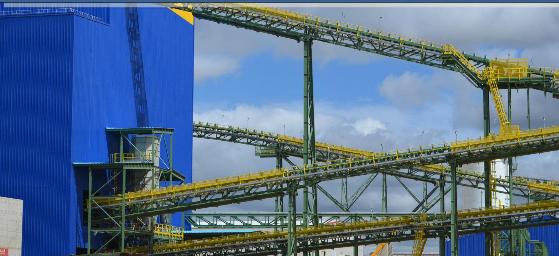
При пересыпке сухой дробленой руды с конвейера в бункер или в другую часть технологического процесса выделяется пыль (в виде мелких частиц дробленой руды). Без улавливания и сбора эта пыль будет попадать в атмосферу.
