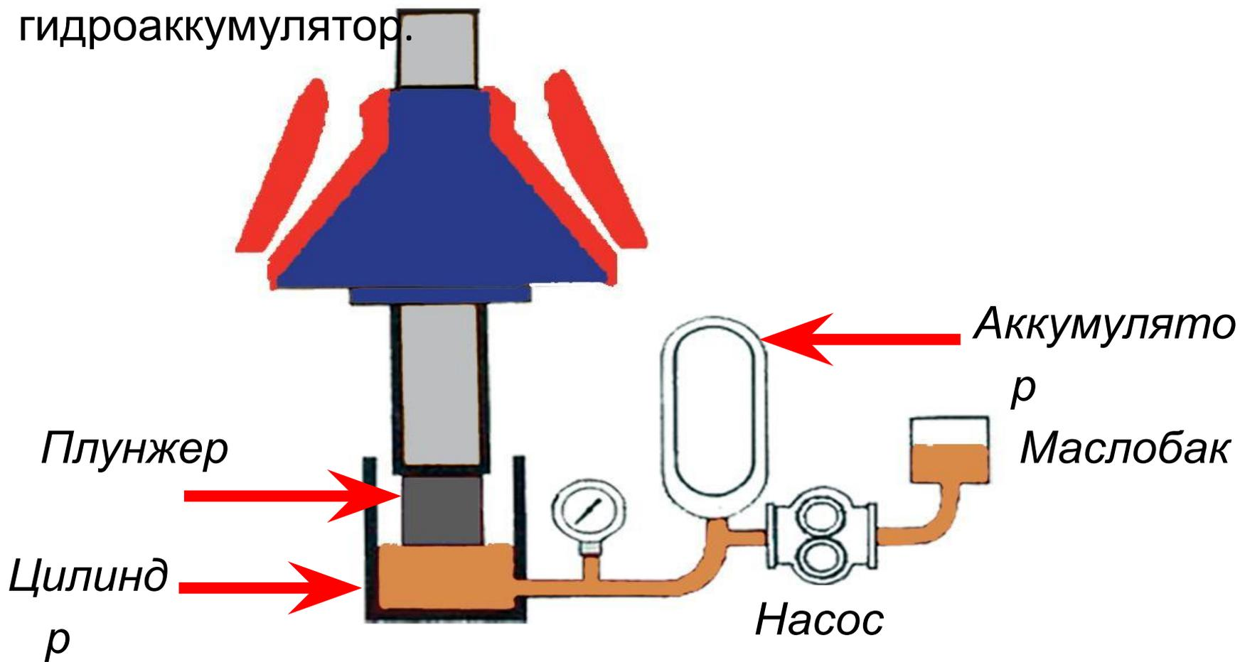
Аккумулятор - это сосуд под давлением, внутри которого находится резиновая камера со сжатым азотом с одной стороны и маслом гидравлической системы регулировки с другой стороны.
