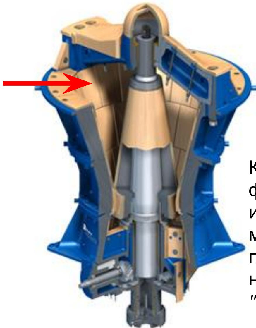
Камера футерована износостойкими металлическими пластинами, называемыми "броня".
