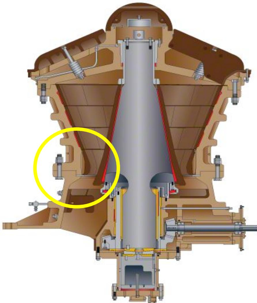
Высота подвижного конуса контролируется элементом определения положения (магнитным датчиком), расположенным в нижней части регулирующего плунжера.
