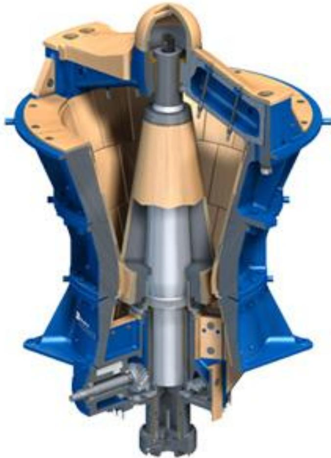
Дробление - это первая стадия измельчения исходной руды до размера, позволяющего выполнить флотацию.
