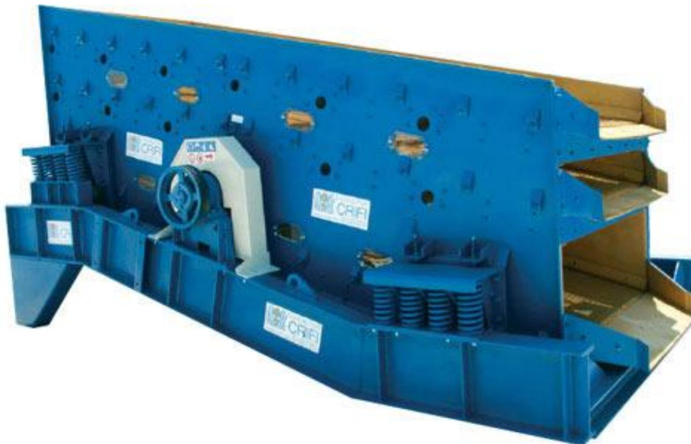
Двухдечный гравитационный виброгрохот предназначен для поддержания материала на поверхности грохочения в движении, вызывая вибрацию каждой частицы на ситах грохота. В двухдечном грохоте предусмотрено верхнее и нижнее сито.
