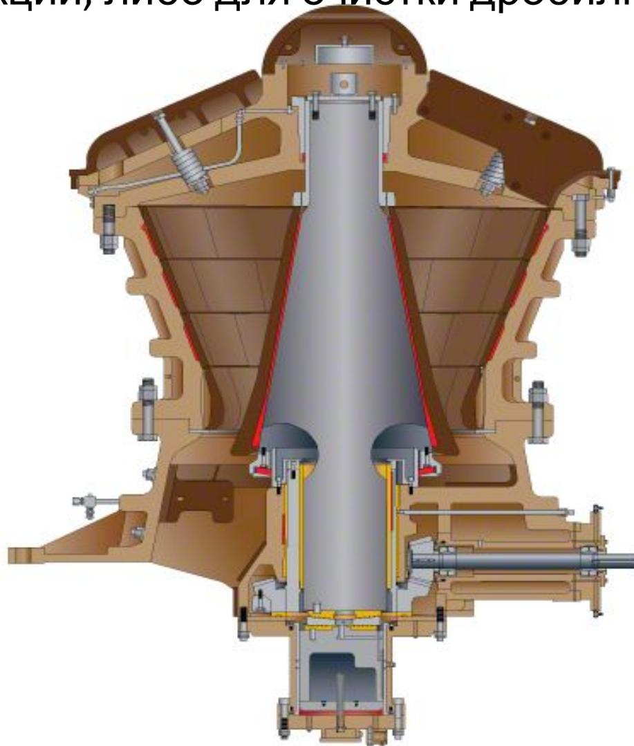
По мере подъема подвижного конуса расстояние между конусом и броней корпуса дробилки уменьшается, что в свою очередь уменьшает размер готовой фракции.
