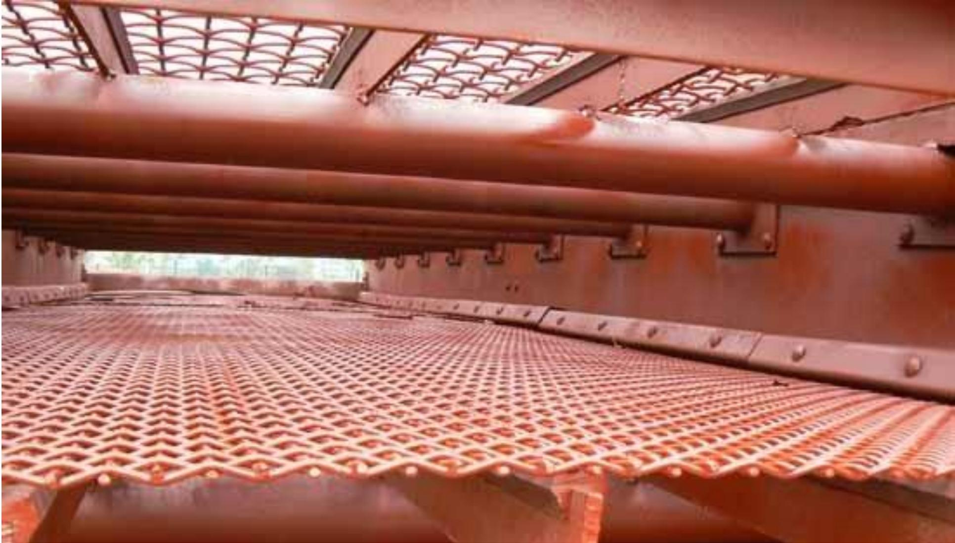
Оба сита имеют квадратные перфорированные отверстия. Большая часть материала размером меньше, чем отверстия, в конечном итоге проходит через сита грохота и попадает в емкость или бункер.
