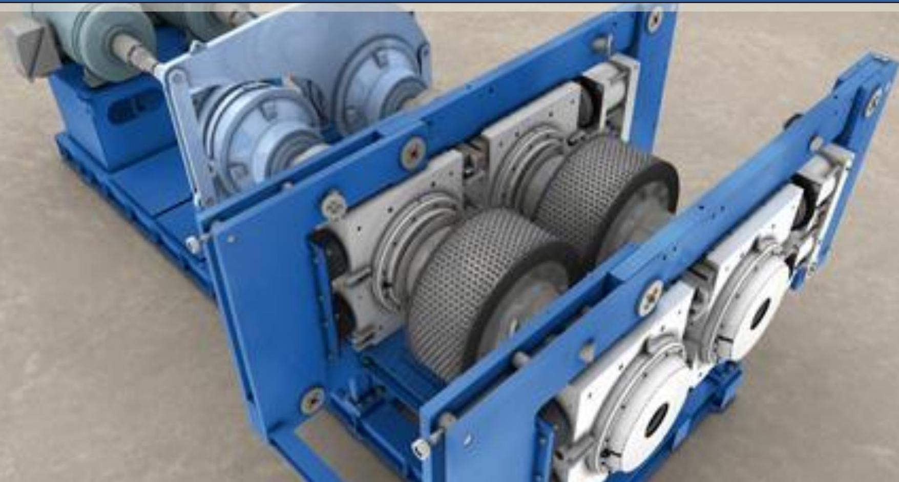
Валковый пресс высокого давления состоит из двух цилиндров (или валков), установленных на горизонтальных осях, которые двигаются в противоположных направлениях так, чтобы поверхности цилиндра вращались навстречу друг другу.
