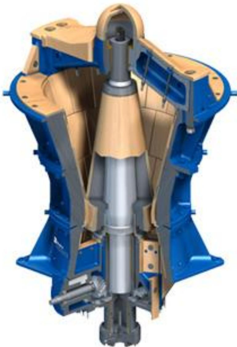
Приводной механизм состоит из двигателя и вала с ведущей шестерней, обеспечивающих качающееся или *вращательное* движение главного вала и подвижного конуса.
