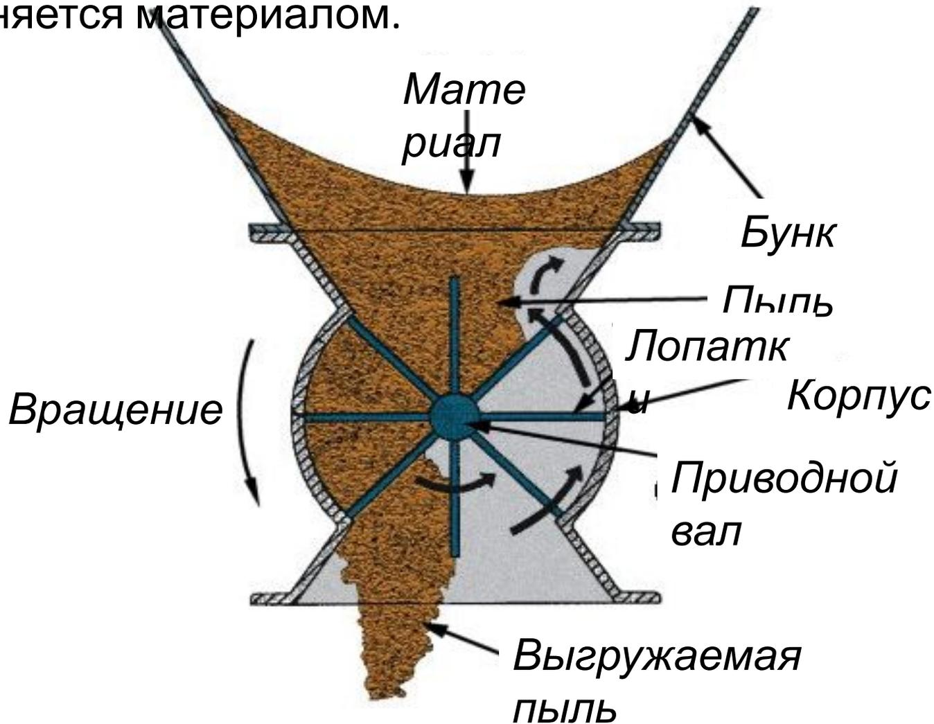
По мере вращения клапана заполненный карман достигает нижней точки. Затем материал падает через отверстие в днище корпуса и попадает в разгрузочный желоб или в расположенную на выходе емкость.
