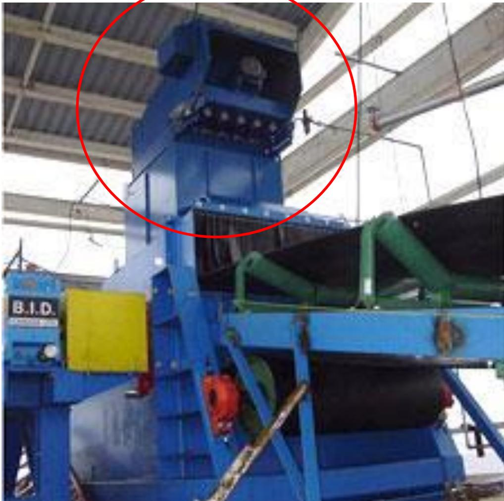
Пылеуловитель удаляет запыленный воздух из верхней части желоба через трубопровод и поддерживает отрицательное давление (вакуум) в разгрузочном желобе.
