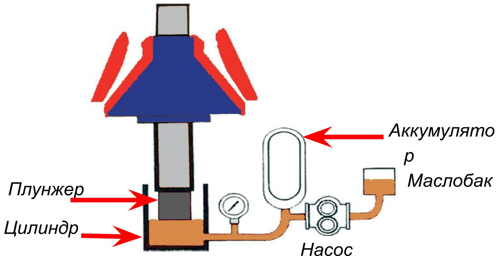
Гидравлическая система регулировки выполняет три важные функции:
