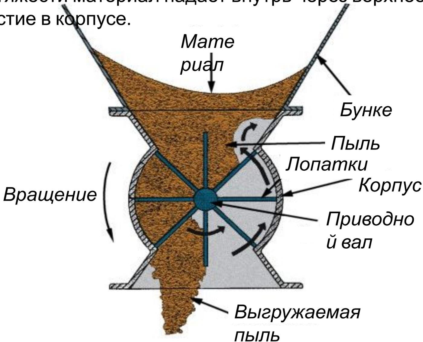
Заполненный карман движется дальше и изолируется от емкости за счет минимального зазора между кромками лопаток и корпусом. Одновременно с этим под емкостью появляется следующий пустой карман, который также заполняется материалом.
