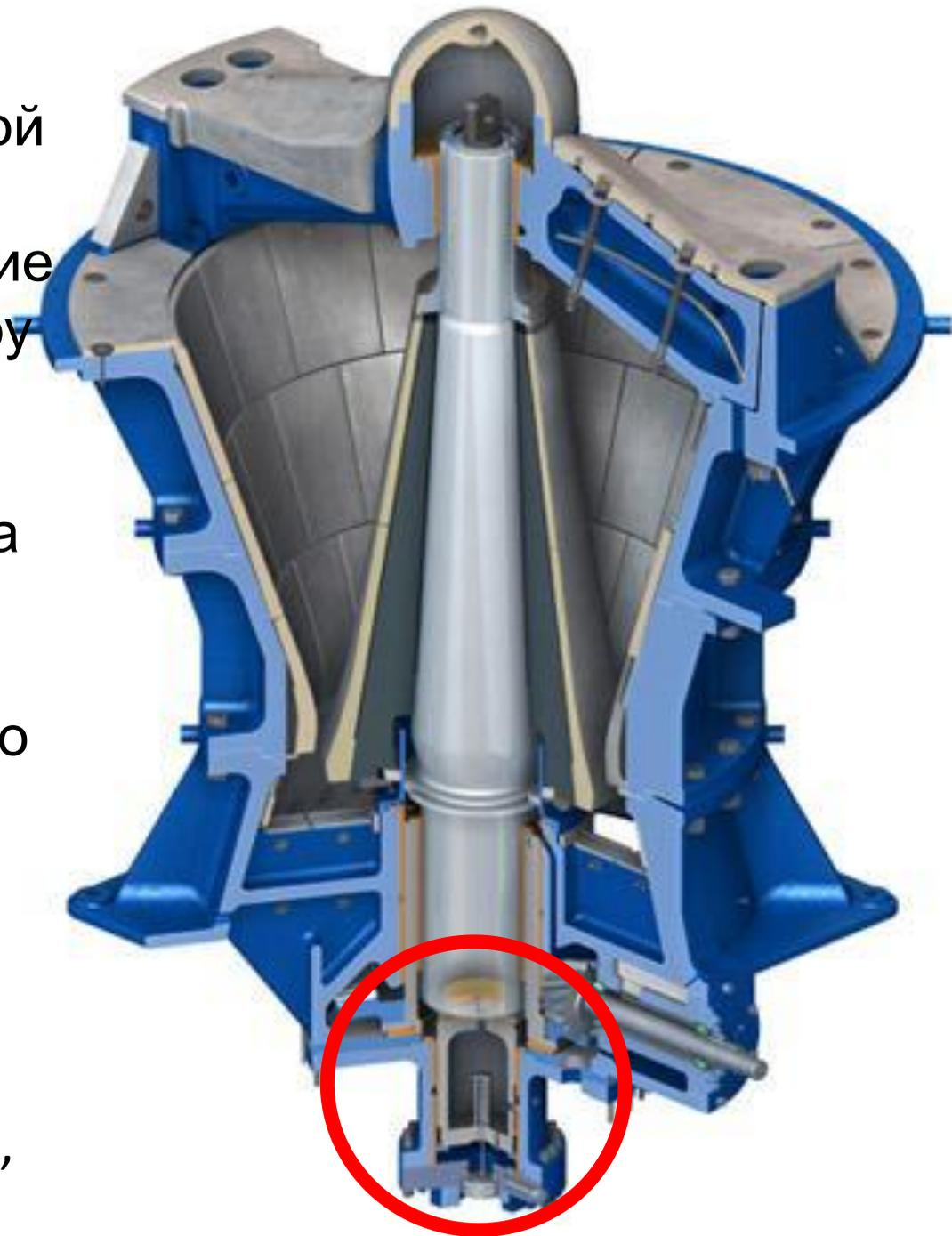
Основные компоненты системы включают гидравлический цилиндр и плунжер, систему подачи гидравлического масла и гидроаккумулятор.
