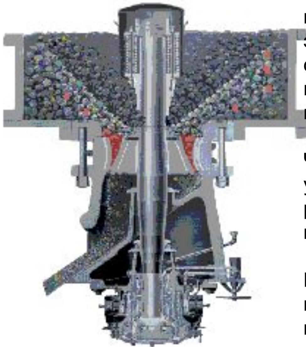
Чаша с футеровками образуют верхний неподвижный дробящий элемент. Подвижный конус с футеровкой дробят материал, ударяя его о неподвижную чашу.
