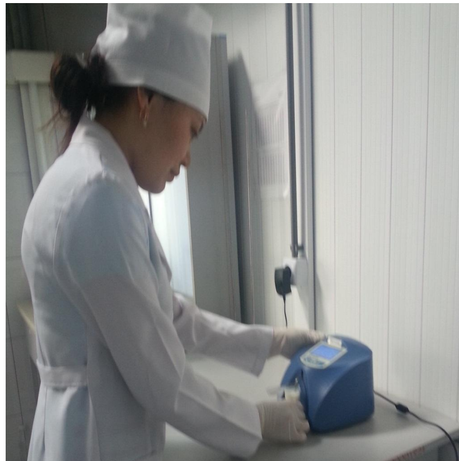
2 – сурет. «Лактоскан SLP» аппараты арқылы сүттің майлылығын, СОМО, тығыздығын анықтау барысы
