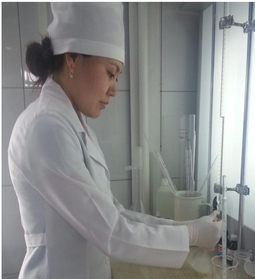
1 – сурет. Сүттің қышқылдығын титрометриялық әдіс арқылы анықтау барысы
