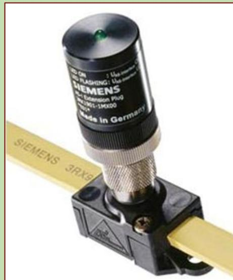
Расширительный штепсель позволяет увеличить максимальную длину сегмента **AS-i** со 100 м до 200 м, а общую протяженность сети – до 600 м.
