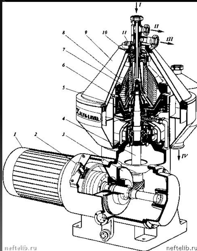
Сверхцентрифуги служат для разделения эмульсий, состоящих из близких по удельному весу жидкостей или суспензий с весьма вязкой жидкой фазой, в которой взвешены небольшие количества очень мелких, и легких твердых частиц.
