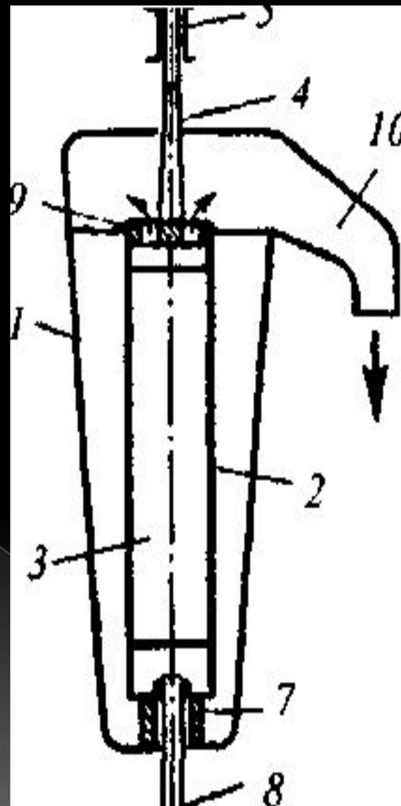
**Сверхцентрифуги изготавливают с осветляющим или разделяющим барабаном. В разделяющем барабане установлена сменная кольцевая диафрагма для регулирования уровня тяжелой жидкости, а в его крышке просверлено отверстие для отвода более тяжелой жидкости.**
