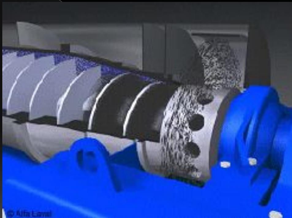
Сверхцентрифуги непрерывного действия имеют повышенную скорость вращения, достигающую 50 000 об / мин. Такие машины требуют разработки специальных электродвигателей и тиристорных преобразователей частоты
