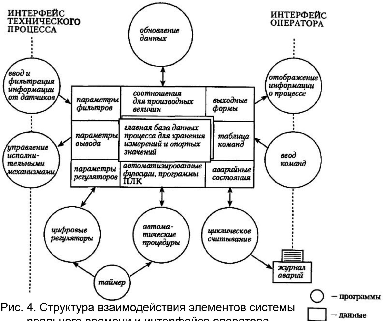
Рис. 4. Структура взаимодействия элементов системы реального времени и интерфейса оператора
