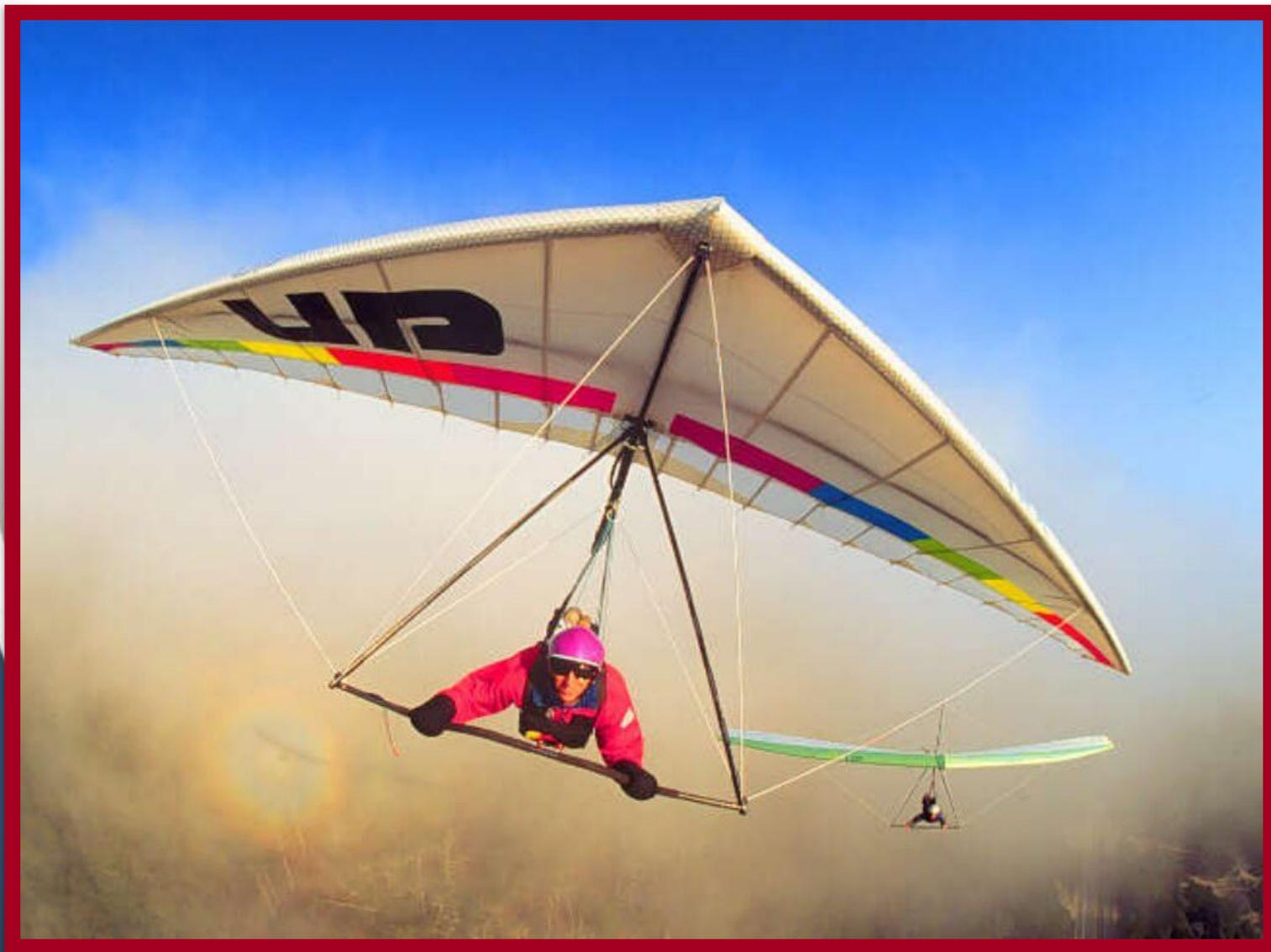
Со склона дельтапланерист может стартовать с ног. На равнине для подъёма дельтапланериста может применяться специальная лебёдка.
