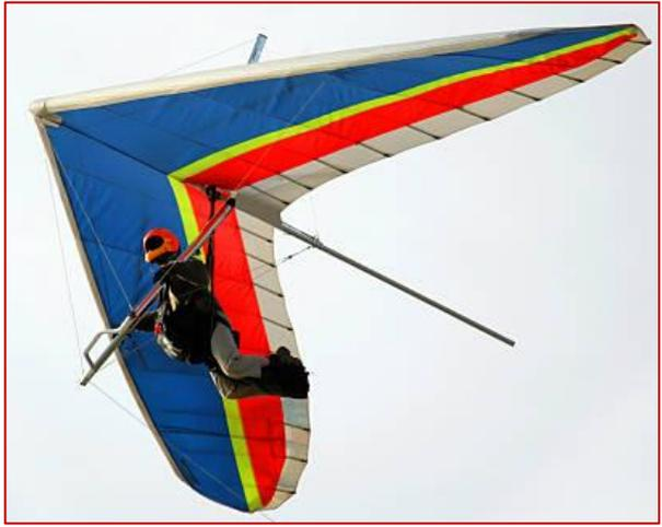
**ДЕЛЬТАПЛАН** — это безмоторный летательный аппарат с крылом из плотной материи — нужную для полёта жёсткость крылу придаёт каркас из лёгкого прочного металла.
