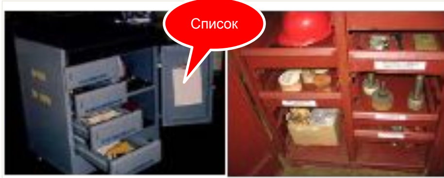
Определяется необходимое количество инструмента. На дверцах и полках ящика размещается информация с перечнем инструментов и принадлежностей, хранящихся на стеллажах
