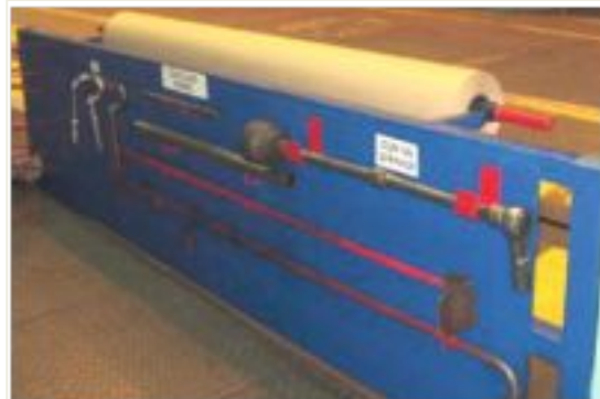
Установка этикеток с названием инструмента и четко обозначенное месторасположение на стенде
