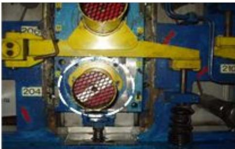
Для проверки вращения на торце валка нанесена белая полоса на темно-красном фоне. Защитная сетка окрашена черным цветом. Проверка производится без затруднений
