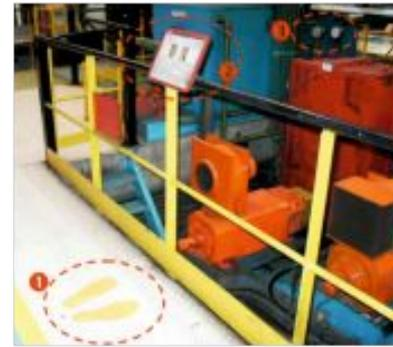
Следы на полу показывают место, где должен стоять оператор, чтобы прочитать, инструкцию по инспекции. В данном случае он должен видеть показания двух манометров
