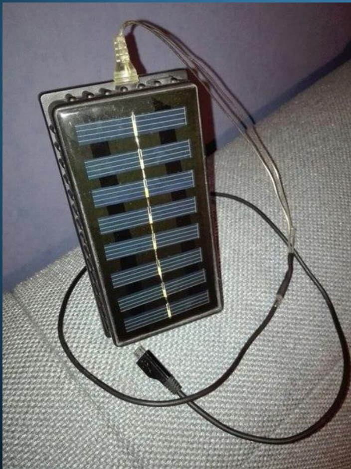
рис.10 зарядное устройство на основе солнечных батарей
