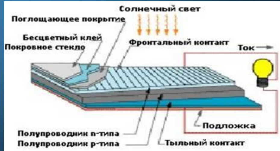
рис.3 устройство солнечных батарей
