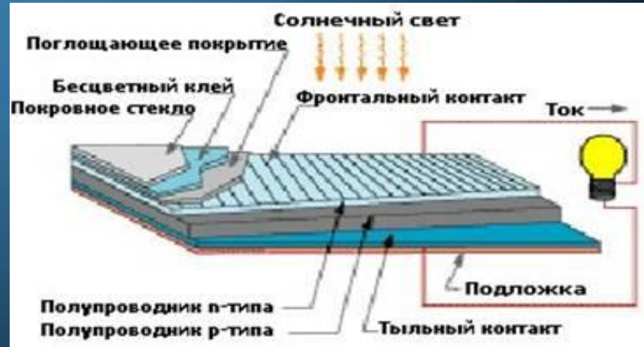
рис.3 устройство солнечных батарей
