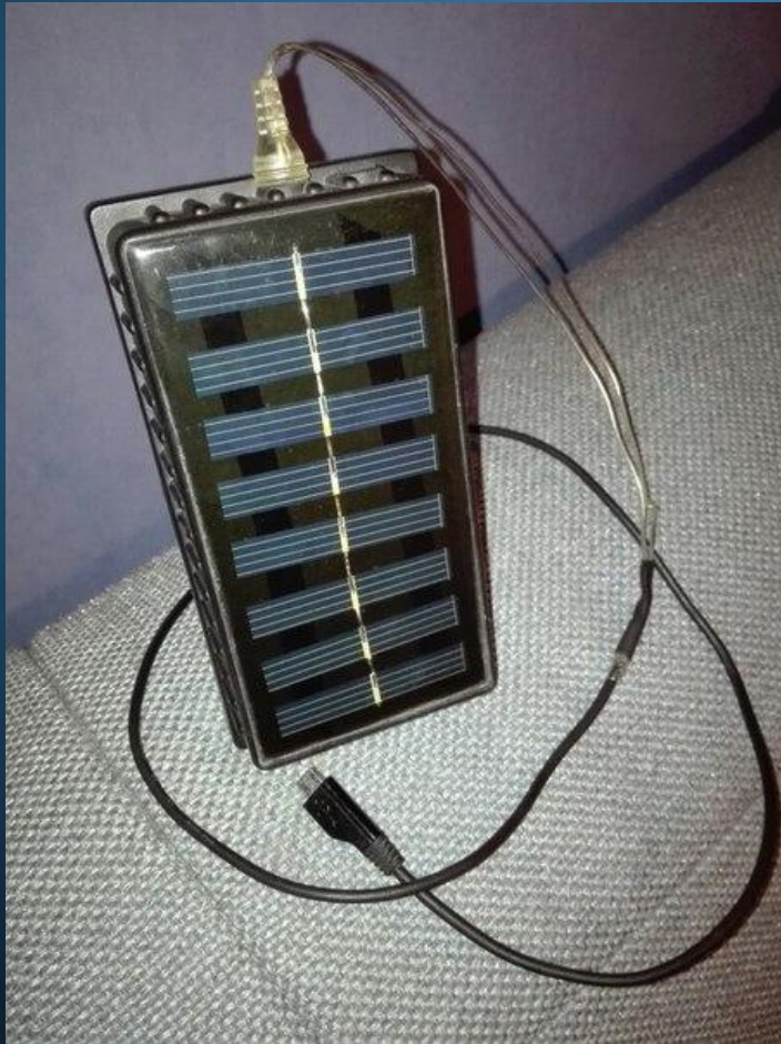
рис.10 зарядное устройство на основе солнечных батарей
