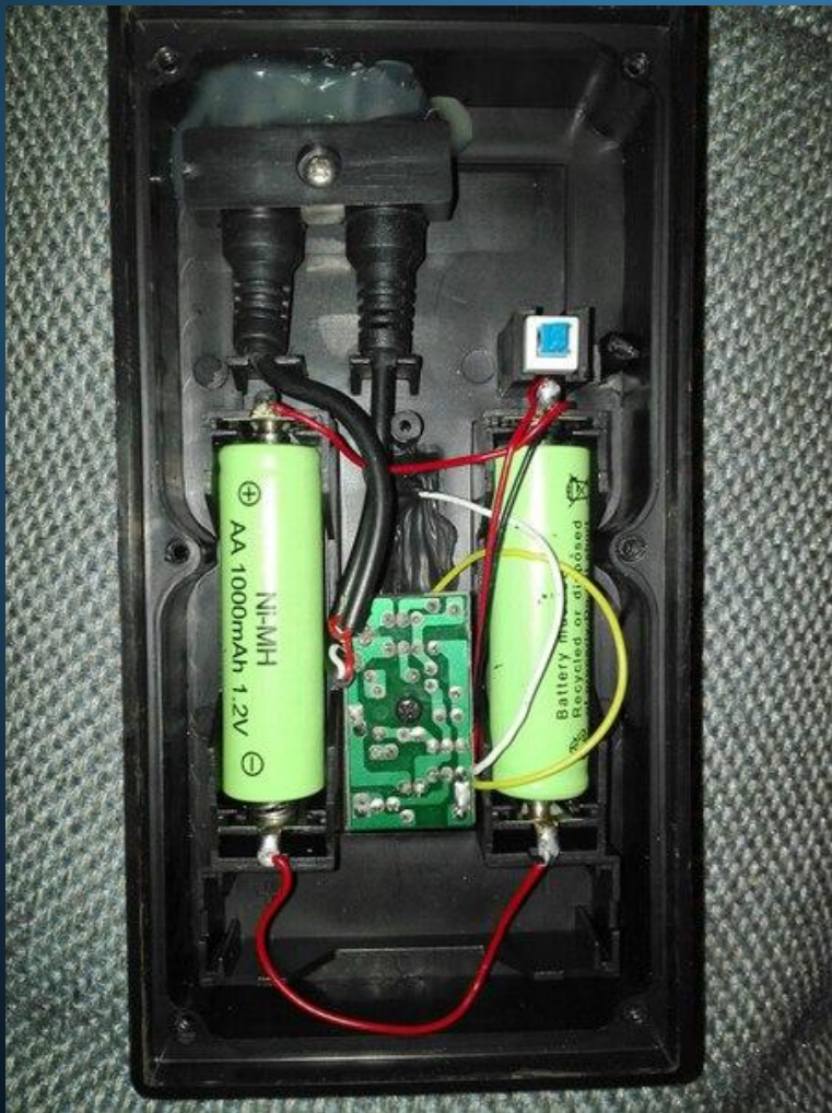
рис.4 внутреннее устройство солнечной батареи
