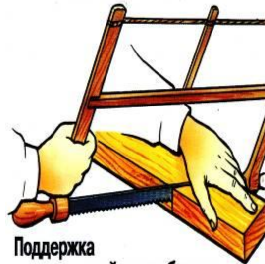
Запиливание по бруску, фиксирующему линию пропила
