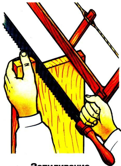
Запиливание по бруску, фиксирующему линию пропила
