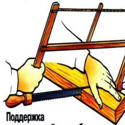
Запиливание по бруску, фиксирующему линию пропила
