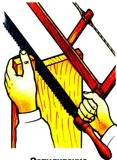
Запиливание по бруску, фиксирующему линию пропила
