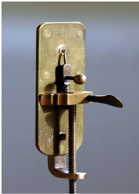
Однолинзовый микроскоп Левенгука, увеличивающий почти в 280 раз
