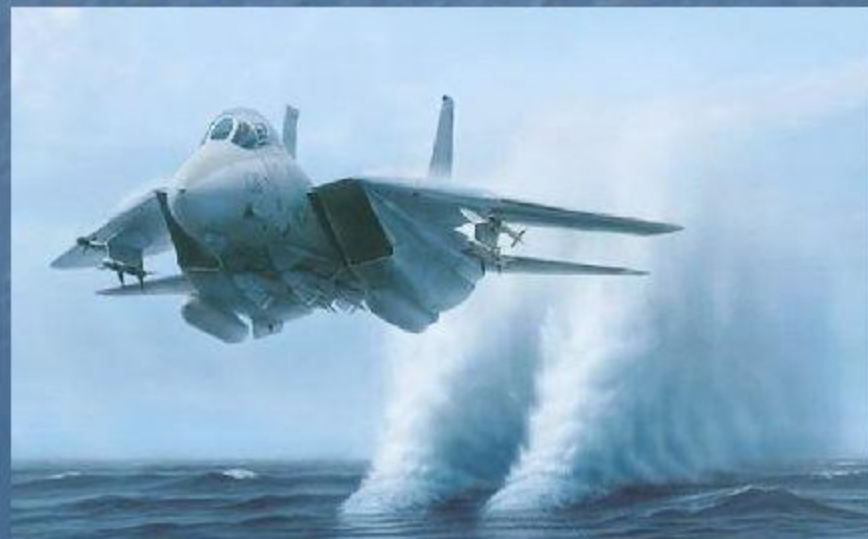
Турбулентное течение за соплами
