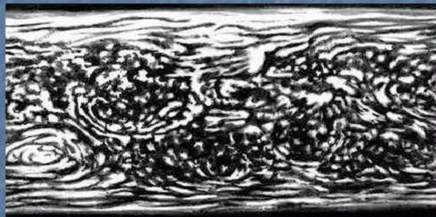
Турбулентное течение за соплами
