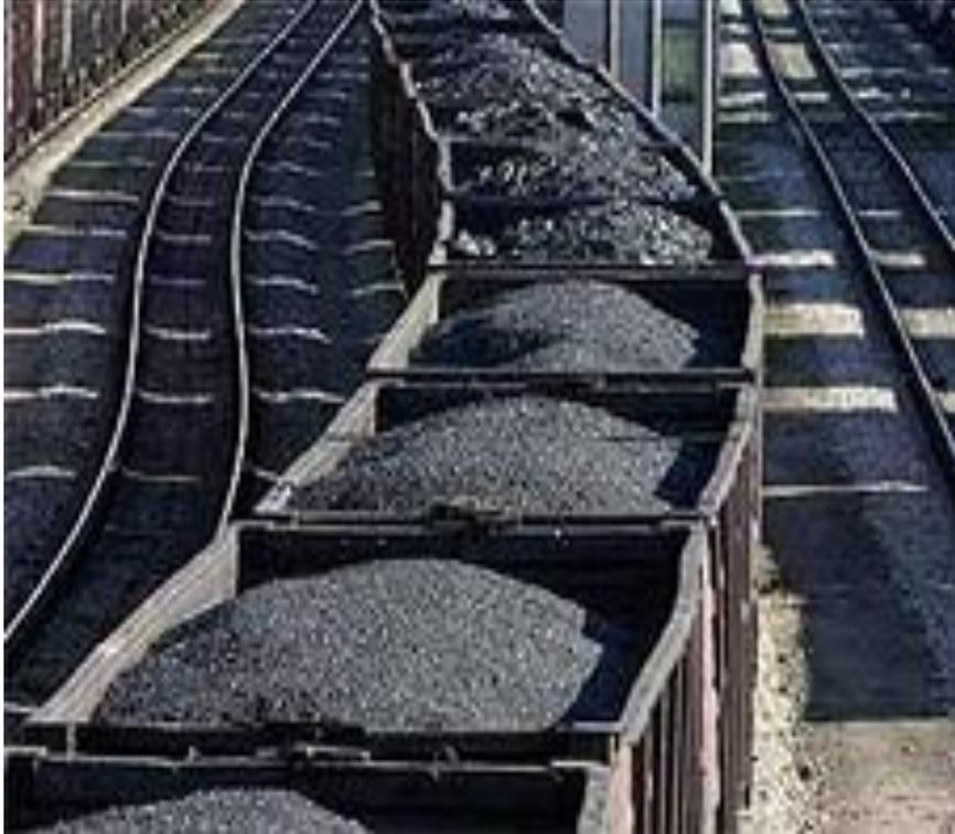
К смерзающимся грузам относятся перевозимые насыпью грузы, которые при температурах наружного воздуха ниже 0 град. С теряют свои обычные свойства сыпучести вследствие смерзания частиц груза между собой и примерзания их к полу и стенкам вагона
