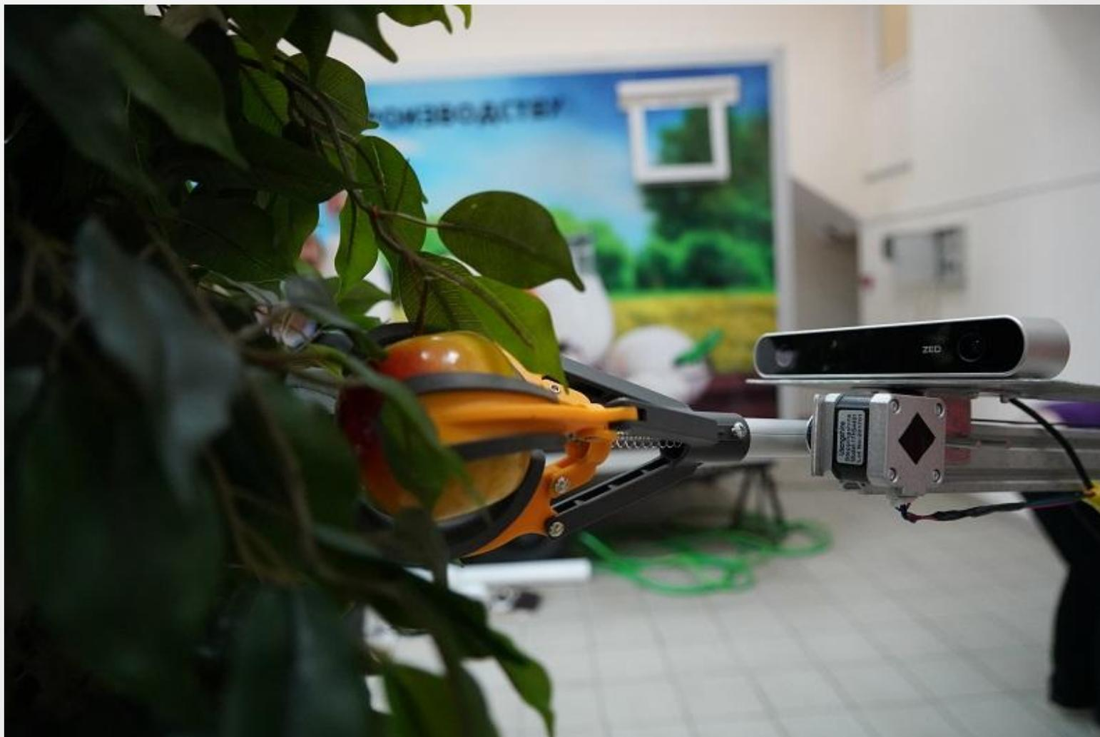
Скорость сбора яблок роботом составляет порядка 10 секунд на плод. За час созданный ФНАЦ ВИМ и Финуниверситетом робот способен собрать 288 килограмм яблок
