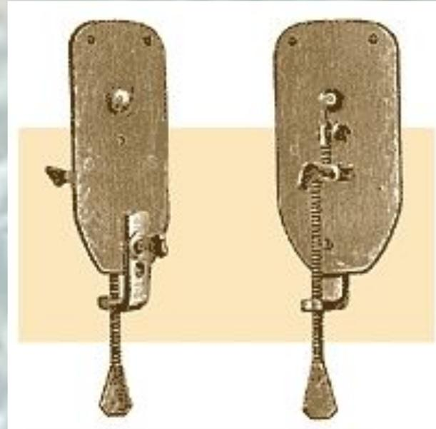
**Всего за свою жизнь А.Левенгук изготовил около 250 линз, добившись 300-кратного увеличения. Устанавливая свои линзы в металлические оправы, он соорудил микроскоп и с его помощью проводил самые передовые по тем временам исследования.**
