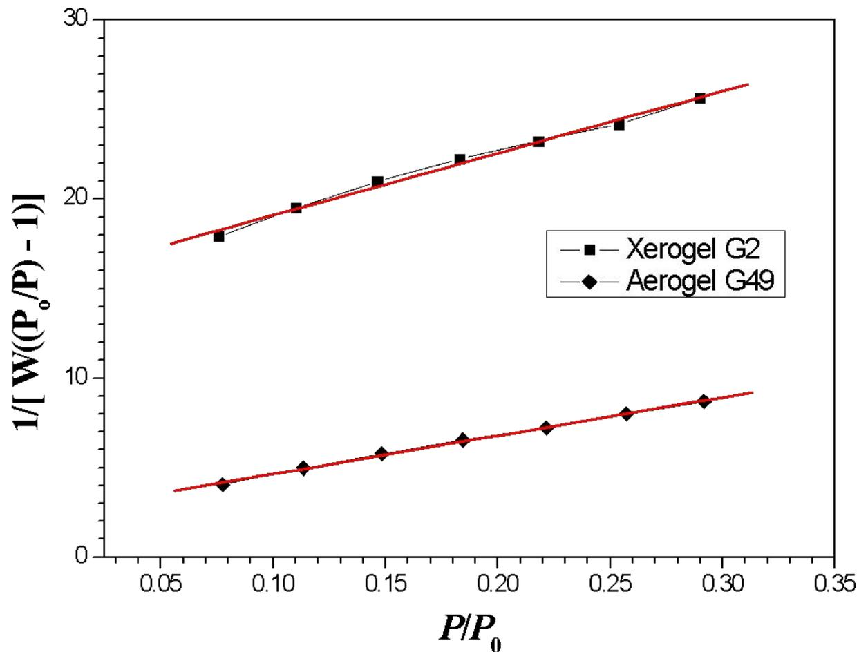
Рисунок 2. Графики ВЕТ для ксерогеля (G2) и аэрогеля (G49) фосфата церия, соответственно.
