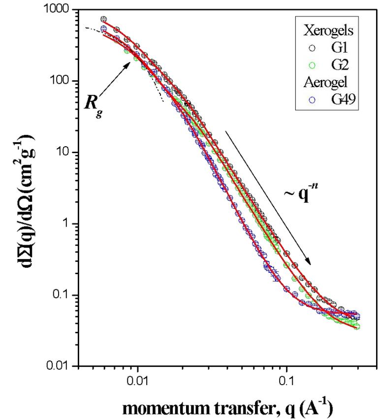
**Рисунок 4.** Дифференциальное сечение малоуглового рассеяния нейтронов  $d\Sigma(q)/d\Omega$  образцами ксерогелей и аэрогеля фосфата церия от переданного импульса  $q$ .
