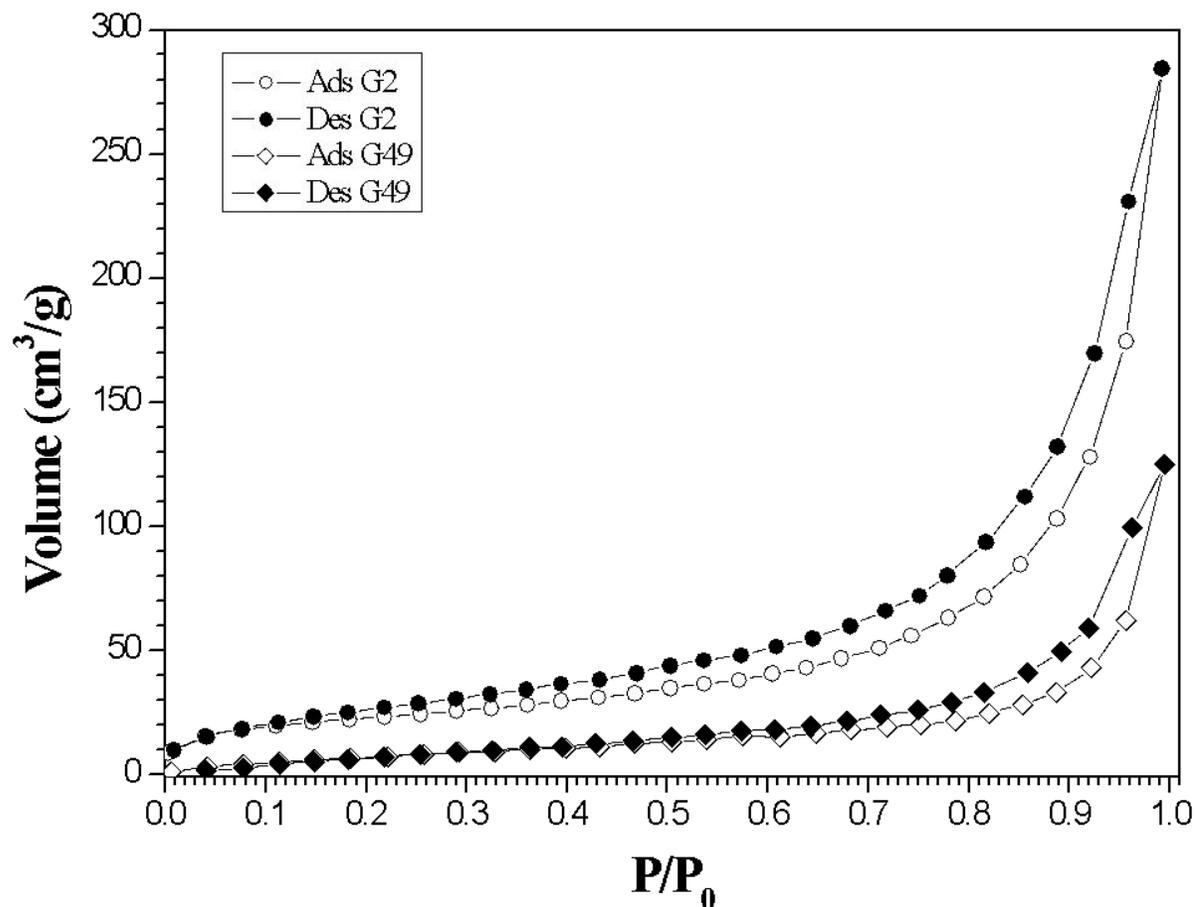
Рисунок 1. Изотермы адсорбции и десорбции ксерогеля (G2) и аэрогеля (G49) фосфата церия, соответственно.
