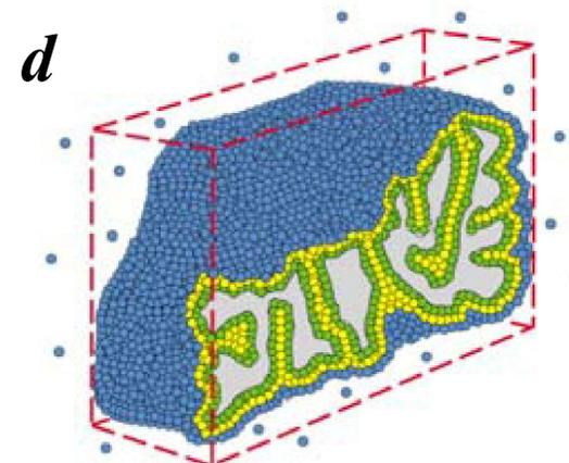
Схематичное изображение процесса сорбции газа. (a). Сильно увеличенная частица твердого вещества. (b). Образование монослоя адсорбированных молекул (насыщение  $\sim 20\%$ ). (c). Капиллярная конденсация, образование мультислоев (насыщение  $\sim 70\%$ ). (d). Полное заполнение всего объема пор (насыщение  $\sim 100\%$ ).
