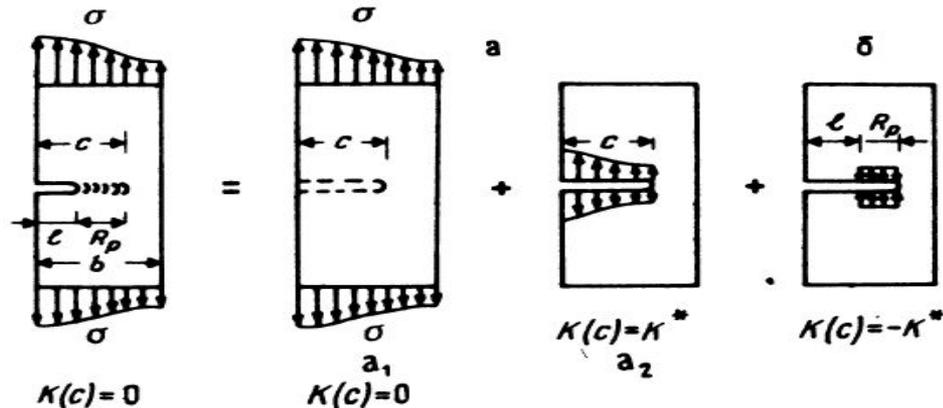
Рис. 8.3. Представление модели Дагдейла в виде двух составляющих а и б (составляющая а разделена на  $a_1$  и  $a_2$ ).
