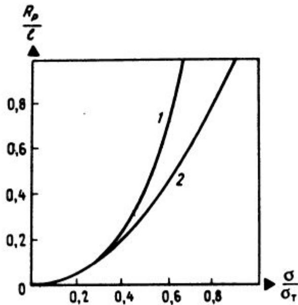
Рис. 8.4. Длина пластической зоны как функция отношения  $\sigma/\sigma_T$ .
