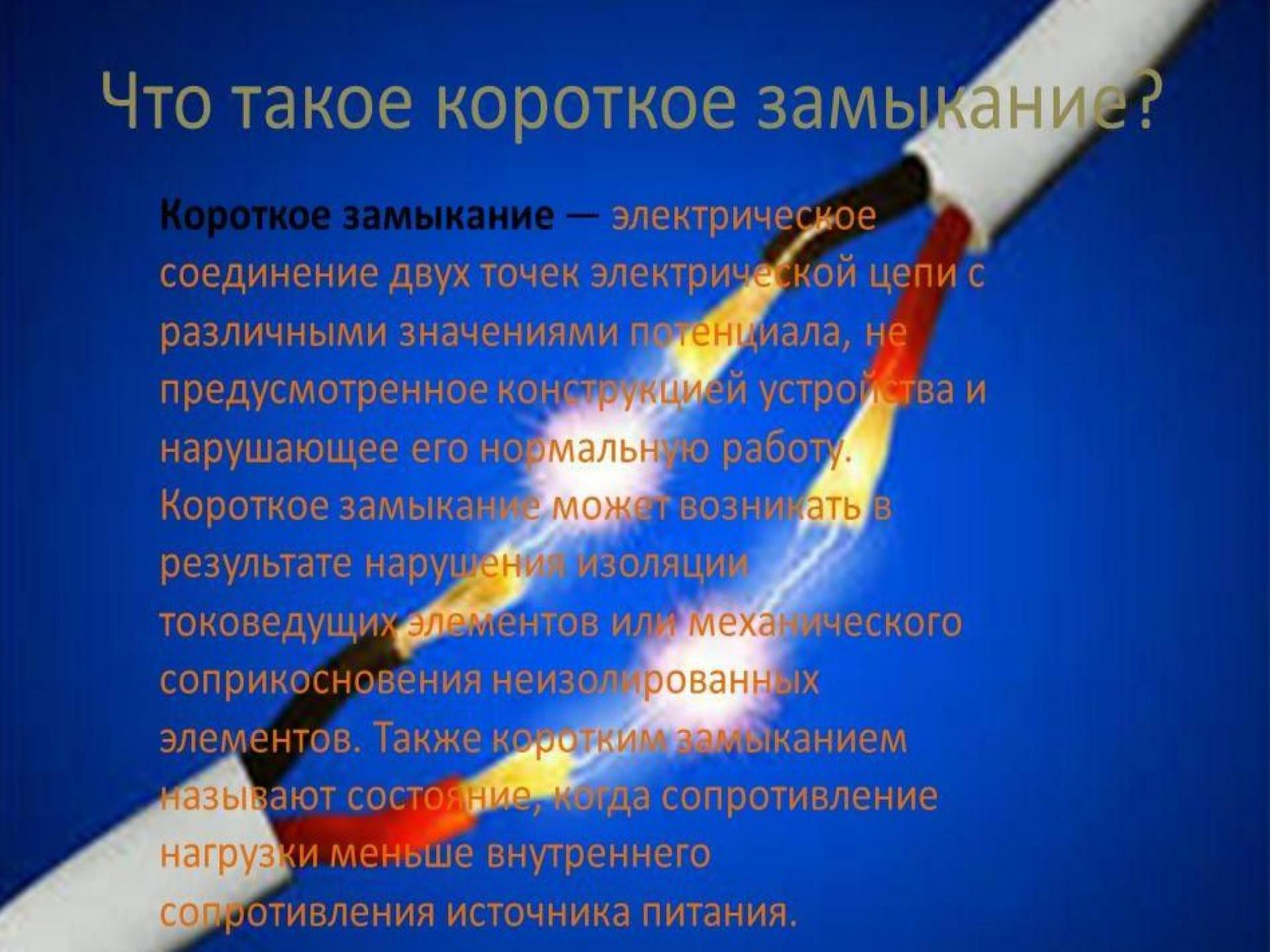
**Короткое замыкание** — электрическое соединение двух точек электрической цепи с различными значениями потенциала, не предусмотренное конструкцией устройства и нарушающее его нормальную работу.
