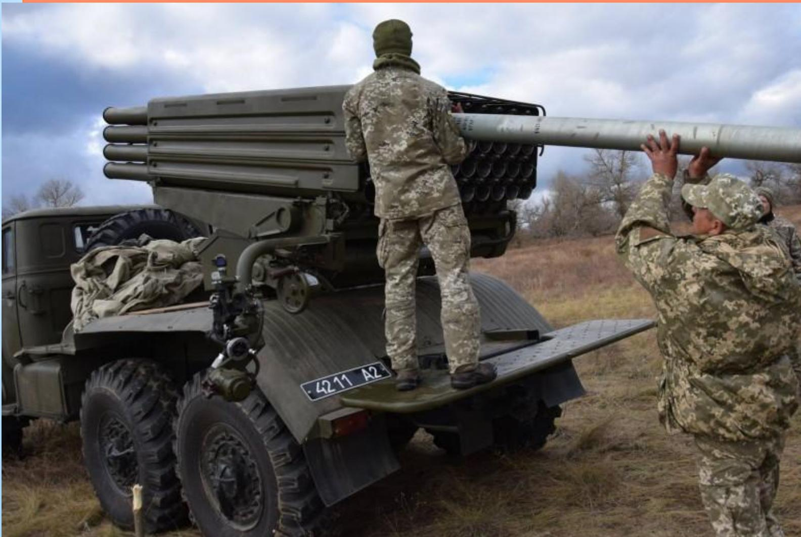
9. повернуть снаряд так, чтобы ведущий штифт снаряда попал в заходную часть направляющего паза трубы, после чего подвинуть снаряд по каналу трубы вперед до упора, до характерного щелчка сигнализирующего стопорение снаряда.
