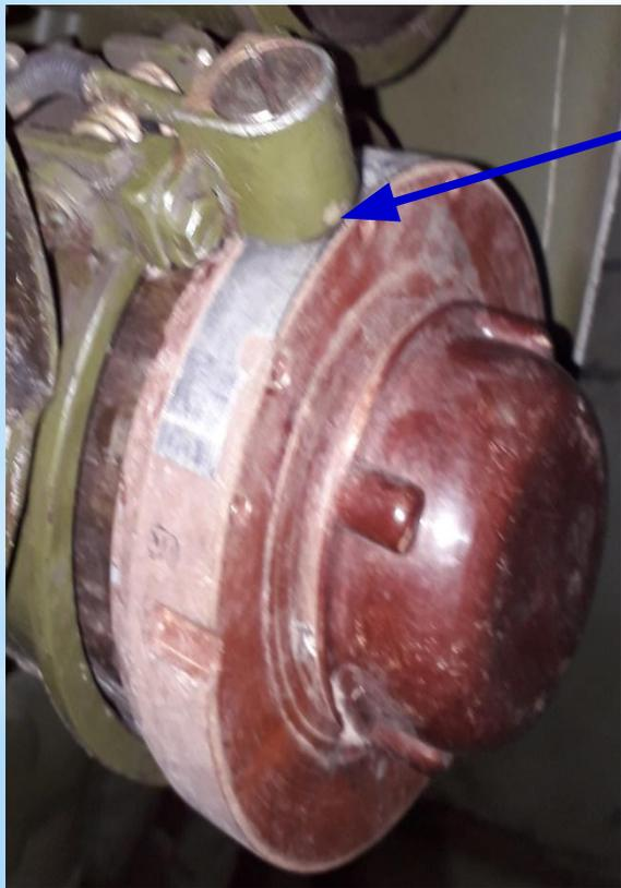
После зарядания проверить правильность положения контактного сектора относительно контакта трубы БМ.
