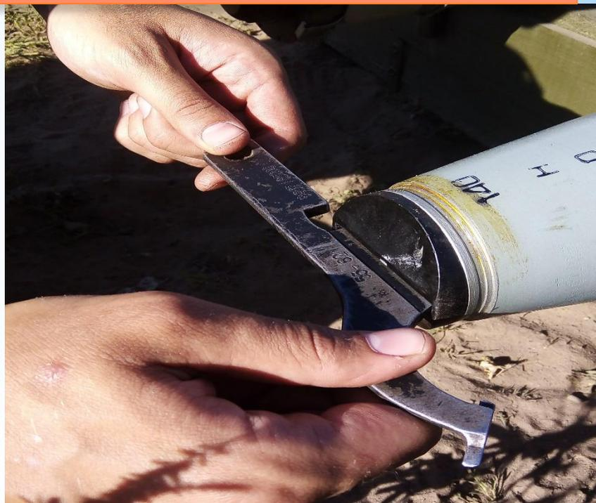
вывинтить **стопор**, а затем холостую пробку под взрыватель из каждого снаряда ключом 9Ф371.03.000;
