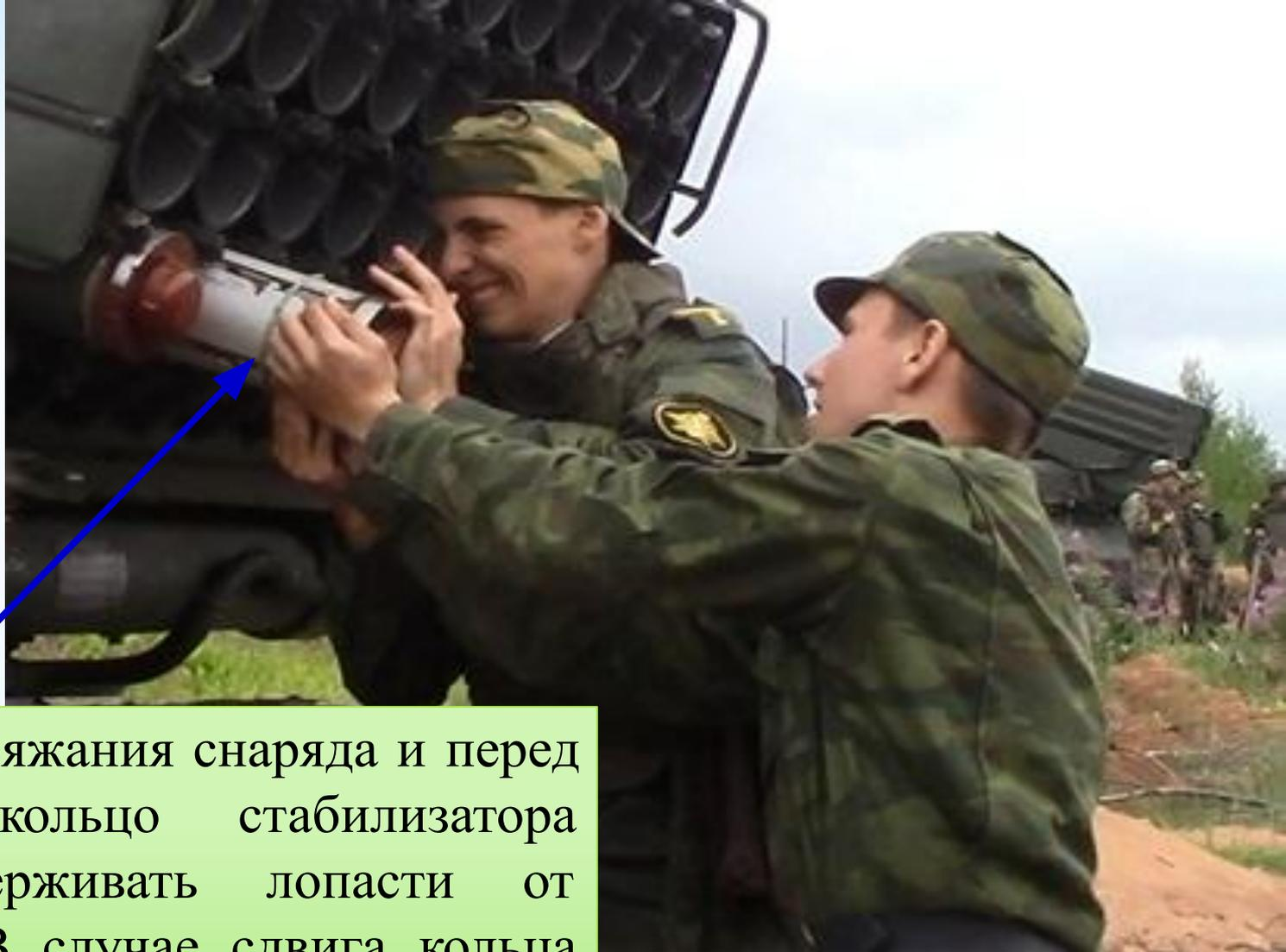
После заряжания снаряда и перед стрельбой кольцо стабилизатора должно удерживать лопасти от раскрытия. В случае сдвига кольца необходимо подвинуть его на лопасти стабилизатора.
