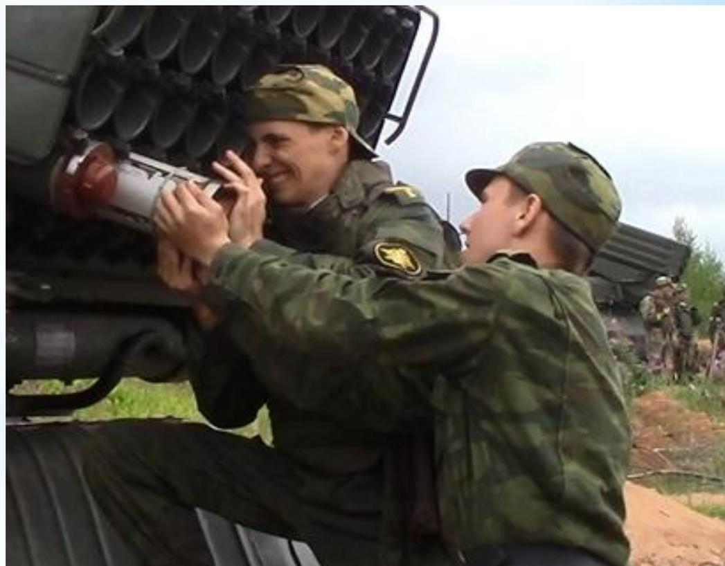
Если снаряд при зарядании продвигается в трубу с большими усилиями, то необходимо произвести разряжание и зарядить им другую трубу. При невозможности повторного зарядания снаряд к стрельбе не допускается.
