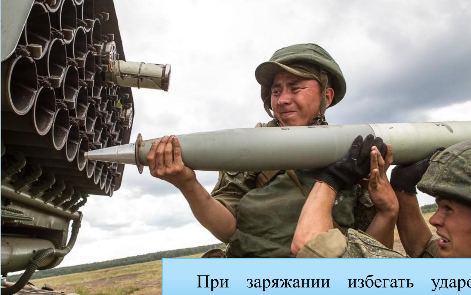
При зарядании избегать ударов головной частью снарядов о контакты и торцы труб машины.
