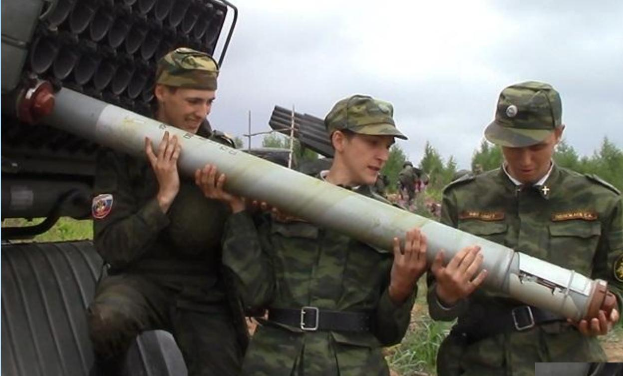
10. досылая снаряд вперед, повернуть его так, чтобы ведущий штифт снаряда попал в заходную часть направляющего паза трубы, после чего подвинуть снаряд по каналу трубы вперед до упора, до характерного щелчка сигнализирующего стопорение снаряда.
