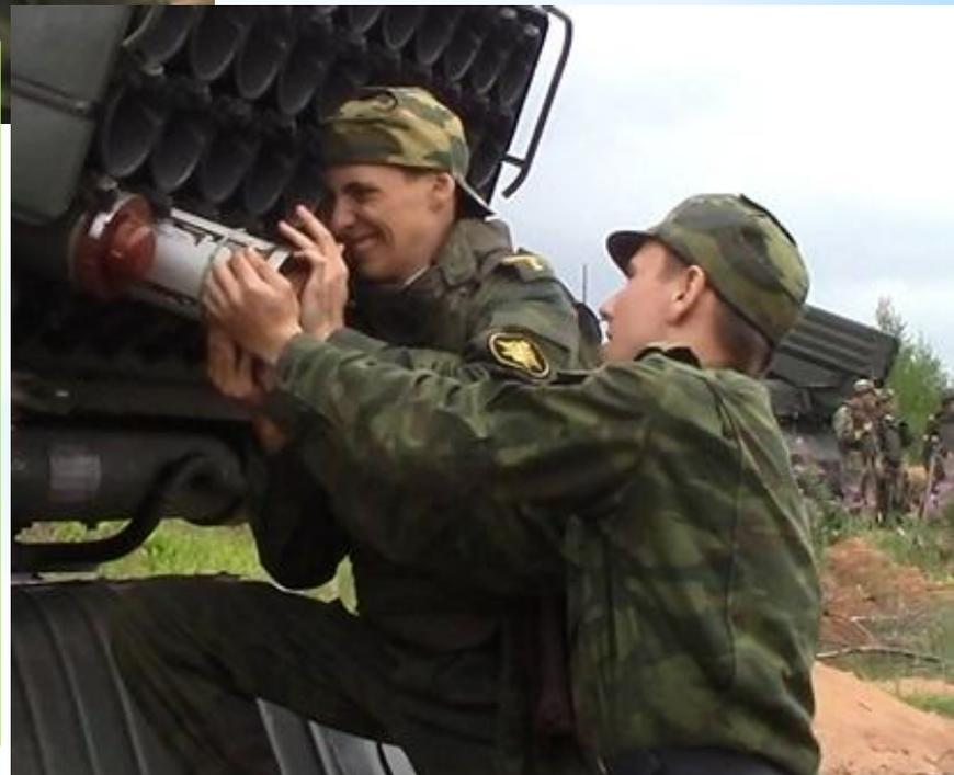
Если снаряд при зарядании продвигается в трубу с большими усилиями, то необходимо произвести разряжание и зарядить им другую трубу. При невозможности повторного зарядания снаряд к стрельбе не допускается.
