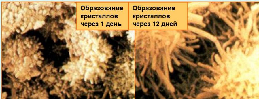
**НАБОР ПРОЧНОСТИ** начинается с образования длинноволокнистых кристаллов (игольчатых кристаллов), которые соединяются своими волокнами друг с другом и, таким образом, образуют прочную структуру. Так из цементного геля образуется цементный камень.
