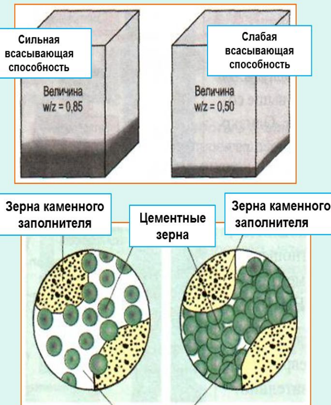
Капиллярные поры в бетоне
