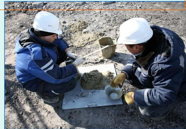
Водоотделение и расслоение в бетонной смеси.
