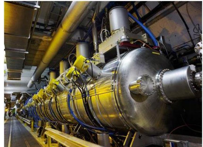
Криомодуль, содержащий четыре резонатора. На каждый из двух пучков приходится два таких криомодуля
