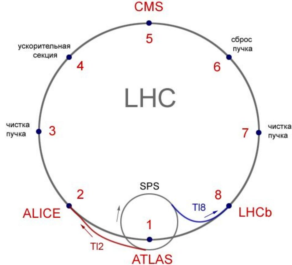
Протонные пучки попадают в LHC из предварительного ускорителя SPS
