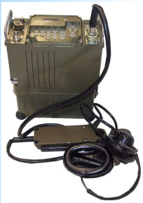
Радиостанция ранцевая УКВ диапазона “Акведук-5УНЕ” обеспечивает радиосвязь в радиосетях ТЗУ
