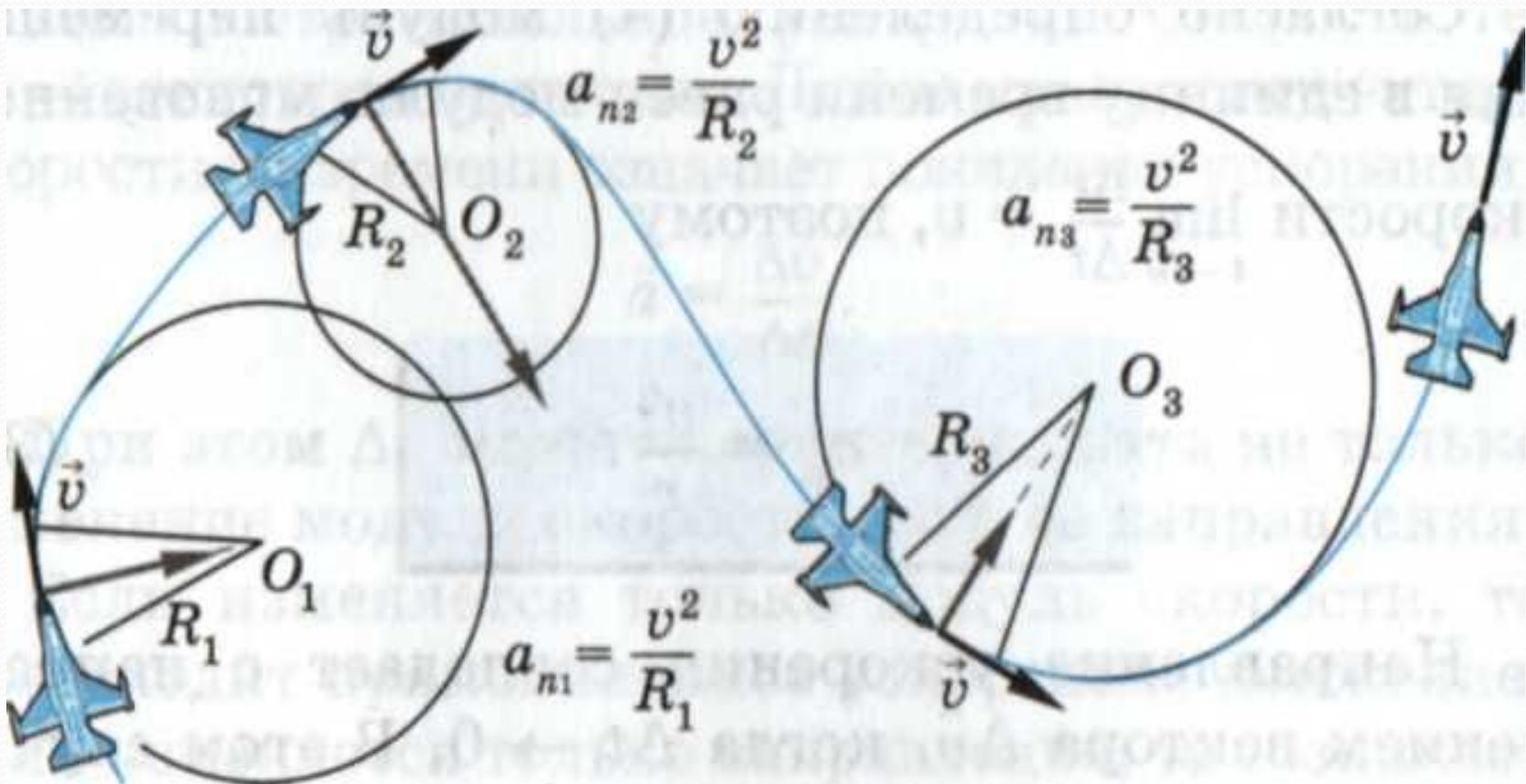
При равномерном движении тела по окружности вектор ускорения всё время перпендикулярен вектору скорости, который направлен по касательной к окружности.
