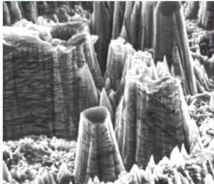
**Изображение предварительно отполированной, а затем подвергнутой ионной бомбардировке поверхности монокристалла меди. Снято в растровом электронном микроскопе. Увеличение - 3000.**
