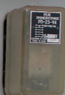
Выходное реле основ. узла генератора Г2 Р204
