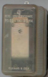
Выходное реле основ. узла генератора Г2 Р202
