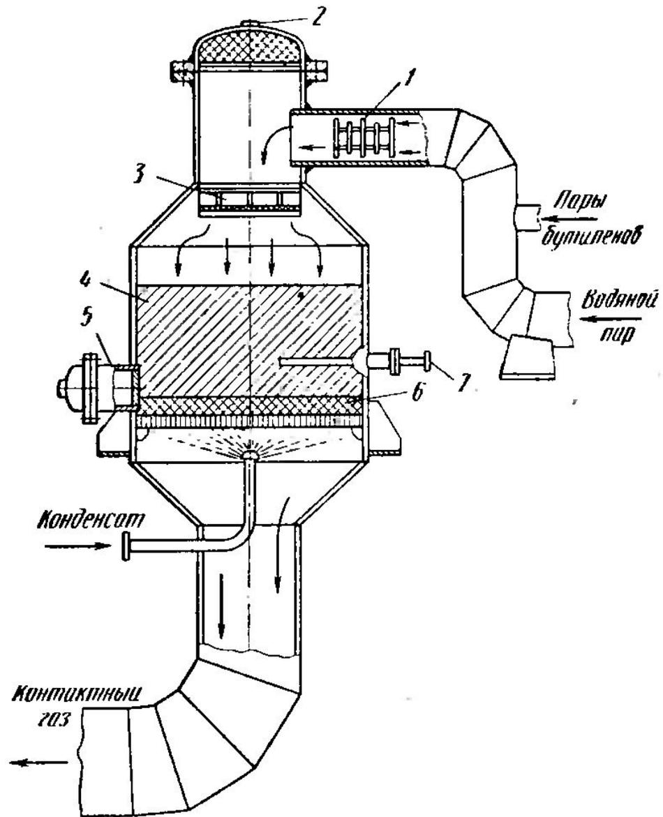
Рис. 137. Реактор дегидрирования бутиленов
