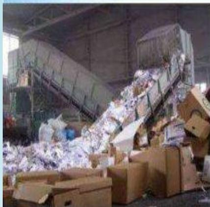
В процессе переработки макулатура, газеты, журналы, картон, а также бумажные отходы измельчаются и отбеливаются для того, чтобы удалить краску и грязь, потом смешивается с водой и перемалываются до состояния бумажной массы.
