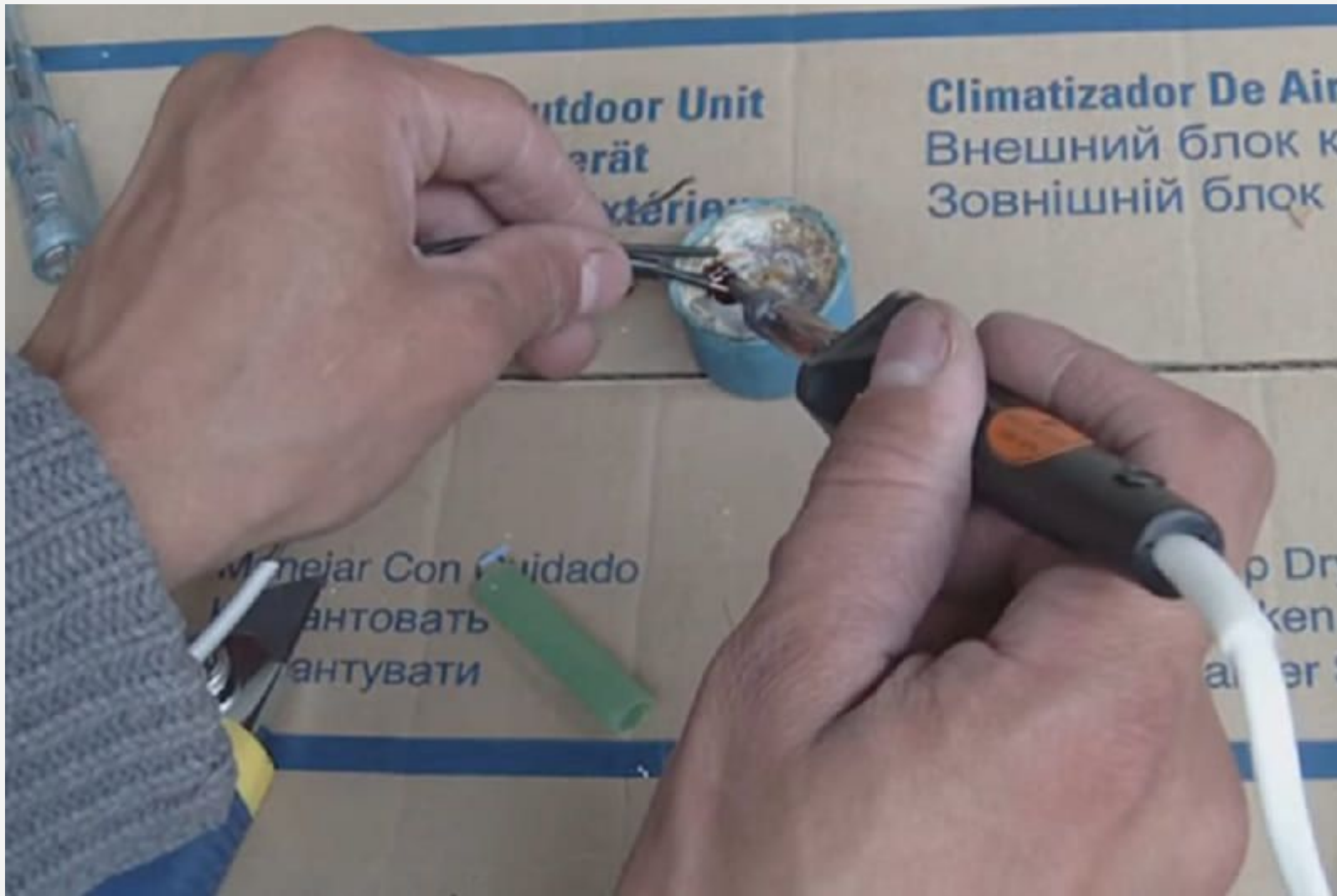
Использование канифоли при пайке
