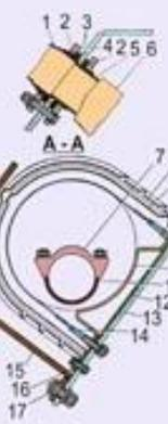
1 - боковой патрубков; 2 - накидной фланец; 3 - прокладка; 4 - листы корпуса; 5 - приемная труба; 6 - термоизоляция; 7 - хомут; 8 - наружный кожух; 9 - внутренний кожух; 10 - опора; 11 - стремянка хомута; 12 - асбестовая прокладка; 13 - листы корпуса; 14 - стремянка; 15 и 16 - защитное ограждение; 17 - болт; 18 - эжектор охлаждения кожухов; 19 - ограждение эжектора; 20 - эжектор отсоса пыли; 21 - глушитель; 22 - турбокомпрессор; 23 - коллектор
