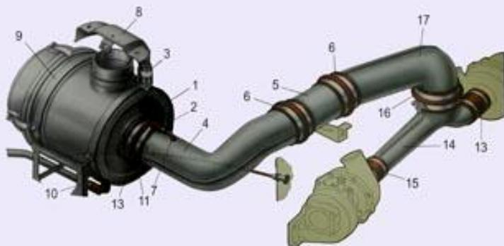
1 - воздушный фильтр; 2 - шланг индикатора засоренности; 3 - индикатор засоренности; 4 - приемная труба; 5 - труба воздуховода; 6 и 12 - хомут; 7 - трубка шланга индикатора; 8 - защитный колпак воздухозаборника; 9 - хомут крепления фильтра; 10 - кронштейн крепления фильтра; 11, 13, 15 и 16 - соединительные шланги; 13 - соединительные шланги; 14 - патрубков; 17 - трубы воздуха
