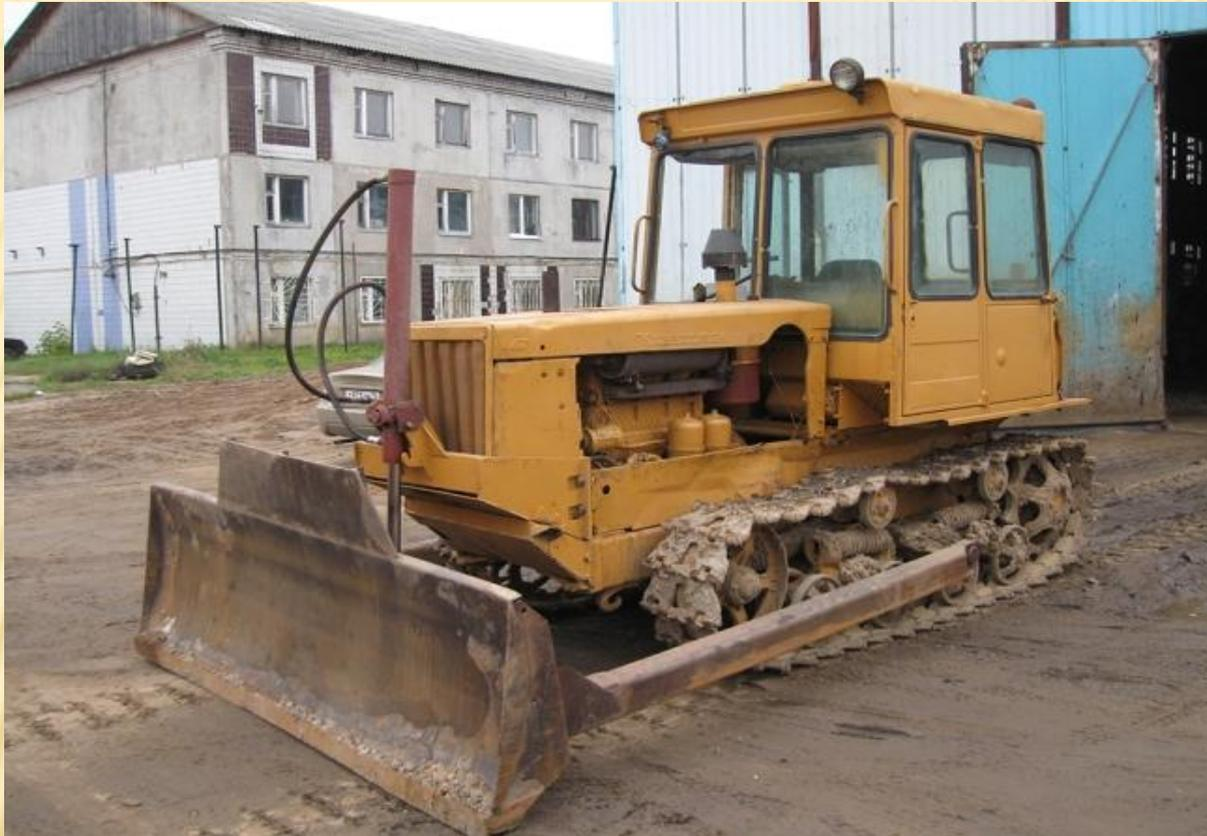
**Трактор ДТ-75** предназначен для выполнения сельскохозяйственных работ, дорожных, строительных, мелиоративных, погрузочно-разгрузочных и транспортных. Используется в сельском и лесном хозяйствах, на торфоразработках и милиорации в совокупности с различными машинами и орудиями. В зависимости от комплектации трактор ДТ-75 имеет модификацию:
