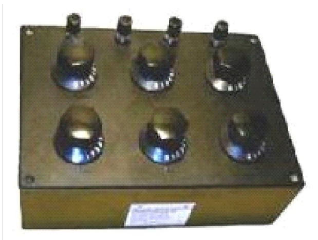
Рис. XX. Магазин сопротивлений и его электрическая схема
