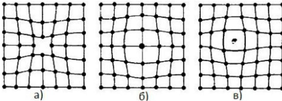
Рис. 1.21: Вакансии (а), примеси замещения (б), примеси внедрения (в)
