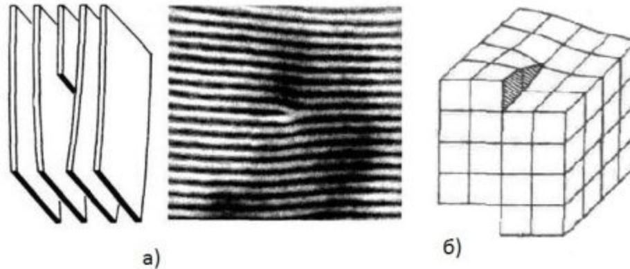
Рис. 1.20: Дислокации краевые (а) и винтовые (б)
