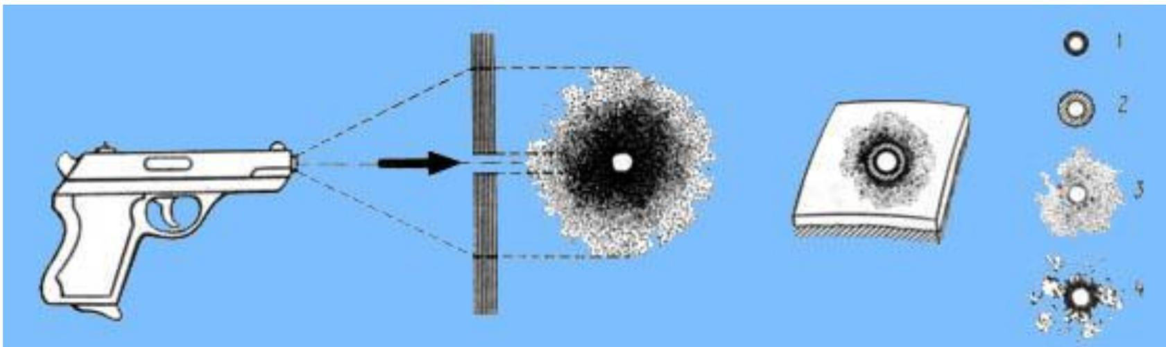
1 – поясок обтирания; 2 – зона деформации материала преграды (разрывы, растяжения и пр.); 3 – зона оканчиваяния и опаления; 4 – зона внедрившихся частиц металла, несгоревших порошинок и пр.
