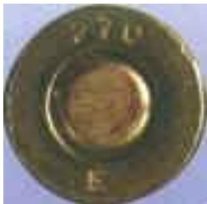
Клеймо на латунной гильзе. Вверху номер завода (270), внизу условное обозначение года изготовления (1953)
