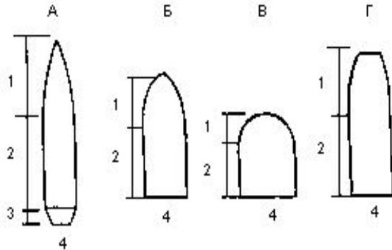
А – пуля с остроконечной головной частью; Б – пуля с закругленной головной частью; В – пуля с полусферической головной частью; Г – пуля с плоскоконечной головной частью.
