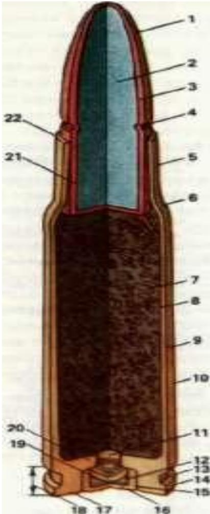
1 — головная часть пули, 2 — сердечник пули, 3 — оболочка пули, 4 — канавка, 5 — дульце гильзы, 6 — скат гильзы, 7 — зарядная камера, 8 — пороховой заряд, 9 — стенка гильзы, 10 — корпус гильзы, 11 — запальное отверстие, 12 — капсюльный состав, 13 — проточка, 14 — фланец, 15 — капсюльное гнездо, 16 — колпачок капсюля - воспламенителя, 17 — дно гильзы, 18 — донная часть, 19 — наковальня, 20 — перегородка, 21 — ведущая часть гильзы, 22 — срез дульца гильзы
