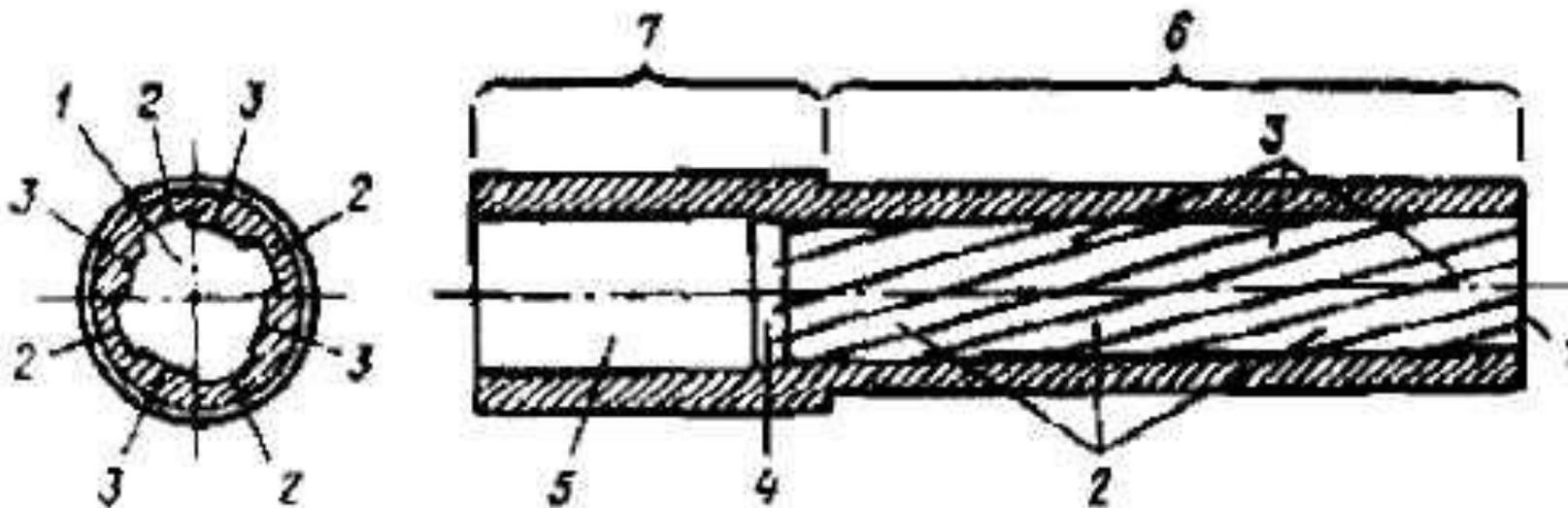
1 — канал ствола; 2 — нарезы; 3 — поля нарезов; 4 — пульный вход; 5 — патронник; 6 — дульная часть ствола; 7 — казенная часть ствола.
