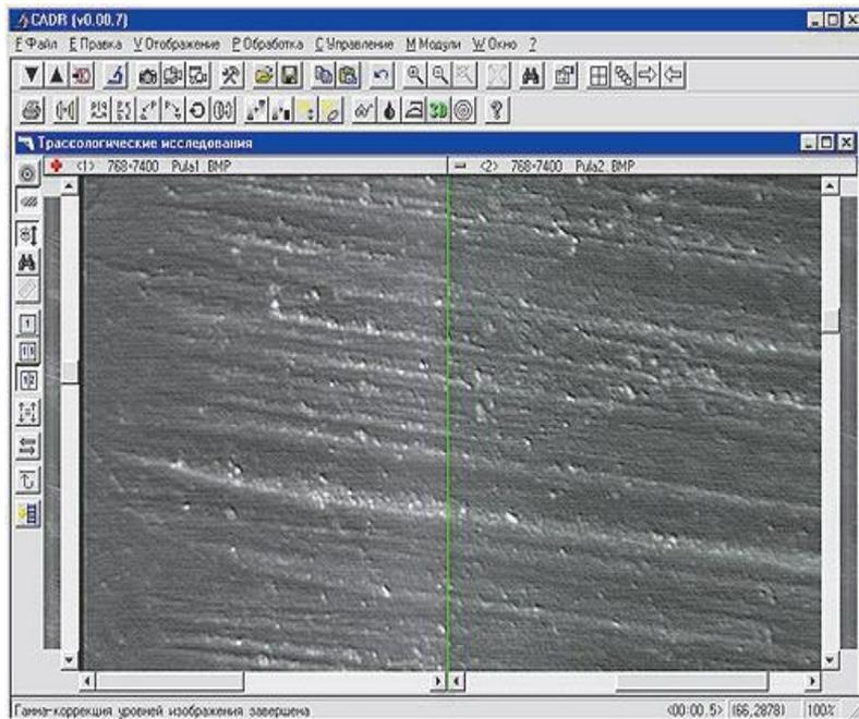
*Исследование (совмещение) трасс на поверхности пули с помощью комплекса БИПАК*
