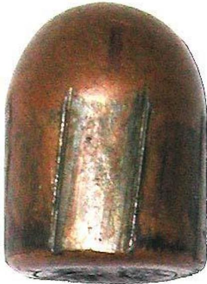
Следы нарезов канала ствола на
