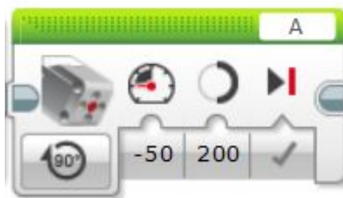
Блок средний мотор для открытия и закрытия манипулятора
