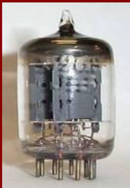
**До 1940-х годов в качестве электронных ключей, позволяющих производить над электрическим сигналом логические операции, применялись электронные лампы. Они были больших размеров и не всегда надежны.**
