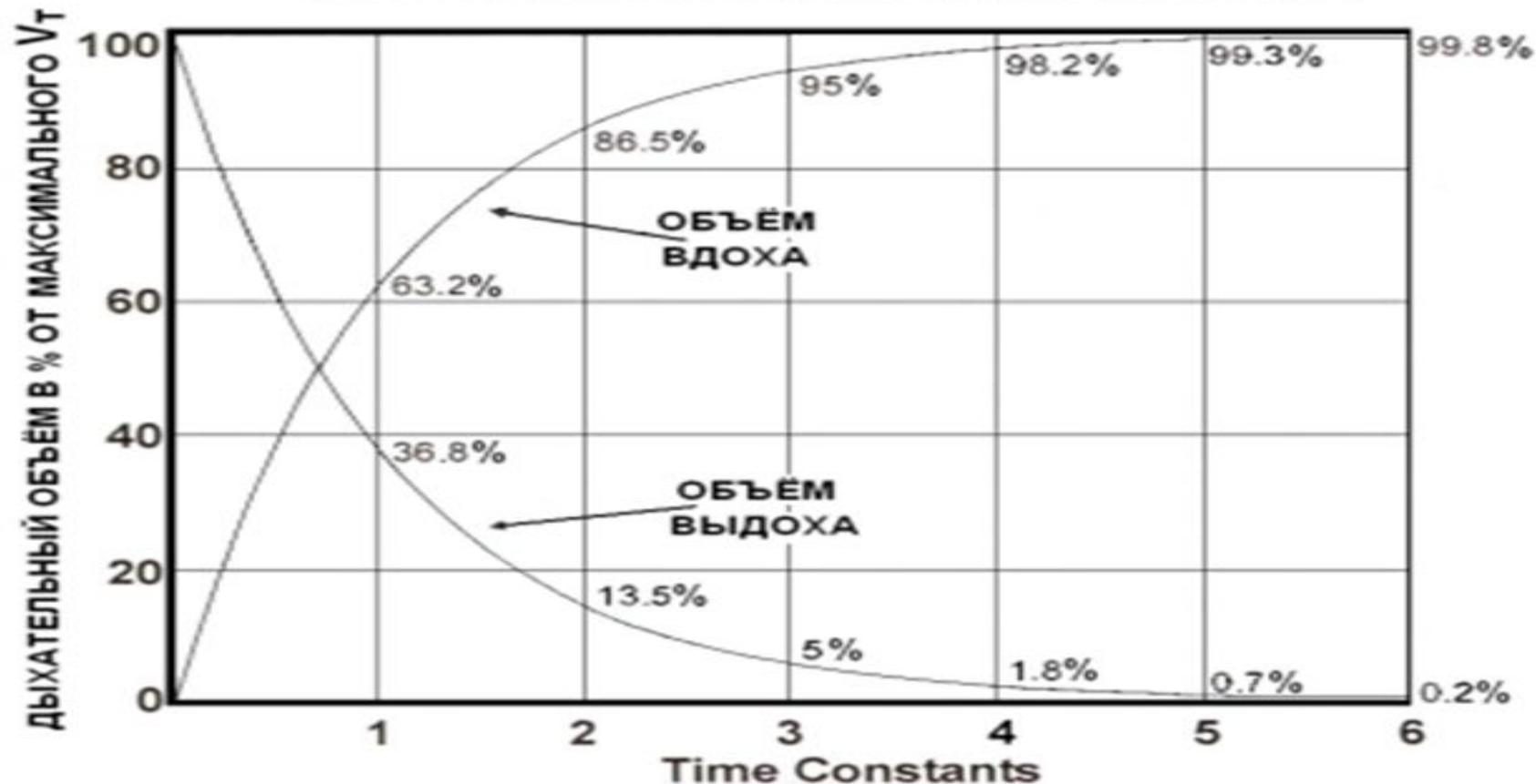
Данный график показывает зависимость процентной величины дыхательного объёма от времени при постоянном давлении вдоха или пассивном выдохе
