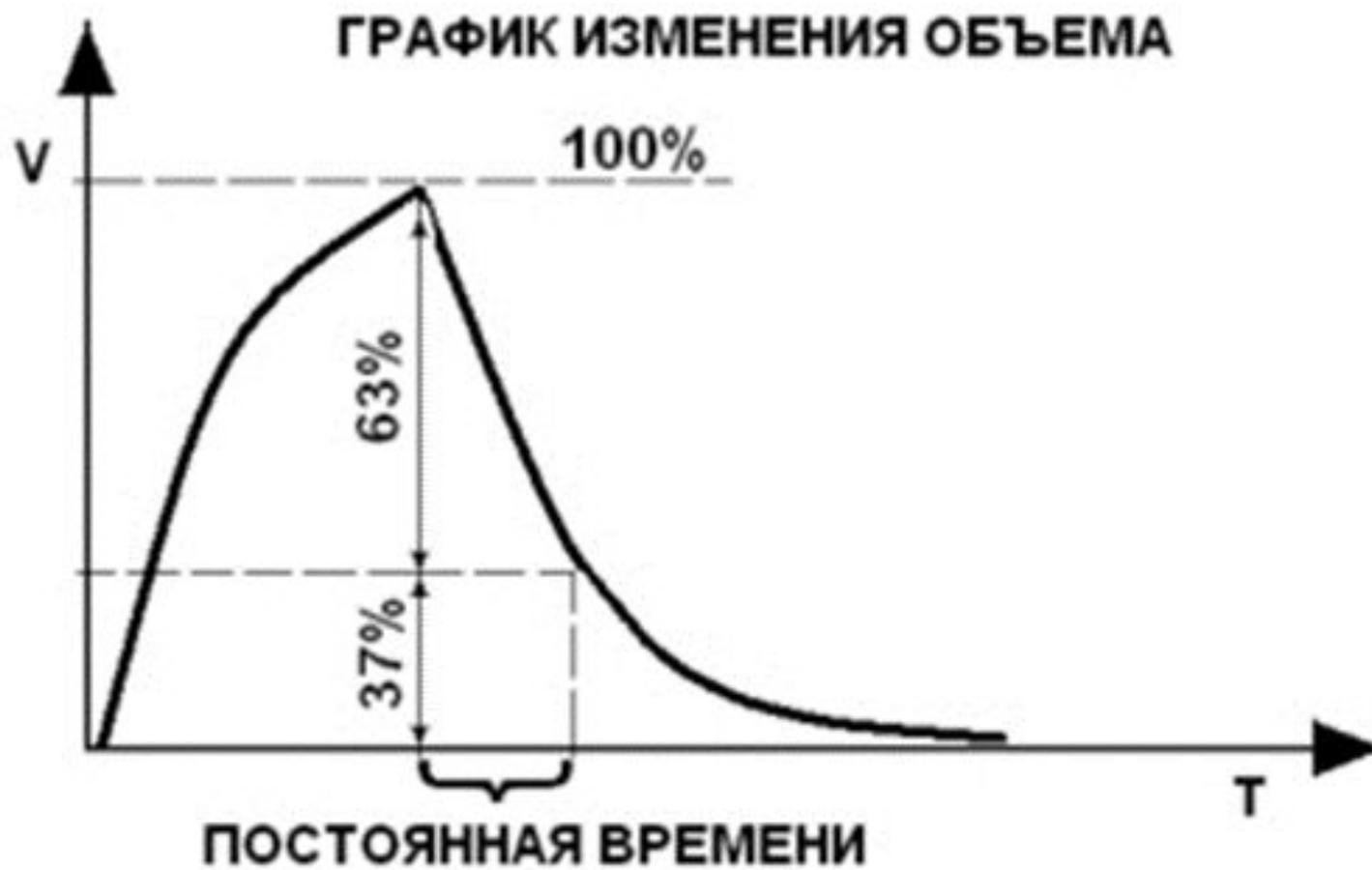
Данный график показывает, как современный аппарат ИВЛ рассчитывает постоянную времени.
