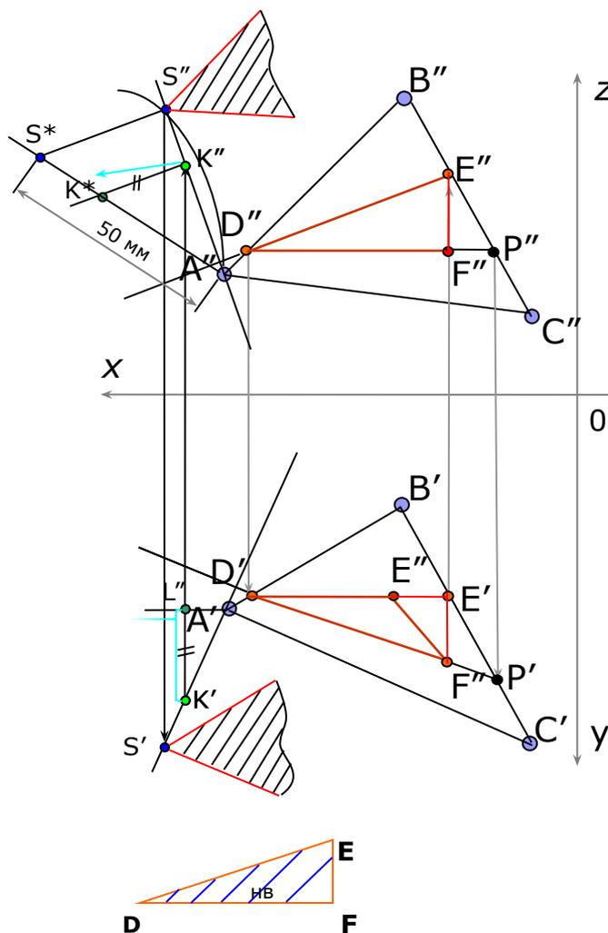
Соединив между собой т.  $A$  и т.  $K^*$  мы получим натуральную отрезка  $AK$ , продлив этот отрезок отложим на нем отрезок равный  $50\text{ мм}$  и отметим т.  $S^*$ .
