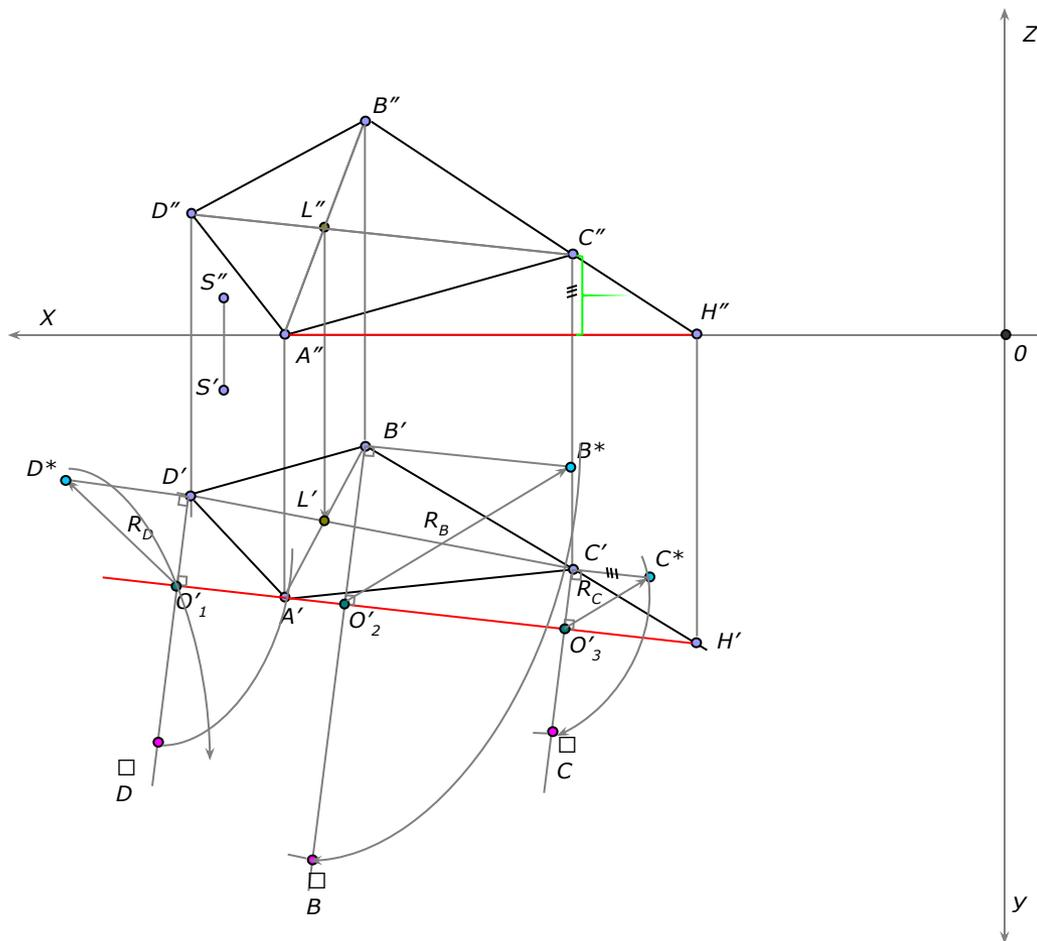
В горизонтальной плоскости проекции из точки  $C'$  опускаем перпендикуляр на ось вращения  $A'H'$ , на их пересечении образуем центр вращения (т. $O'_3$ ) соответствующей точки  $C$ .
