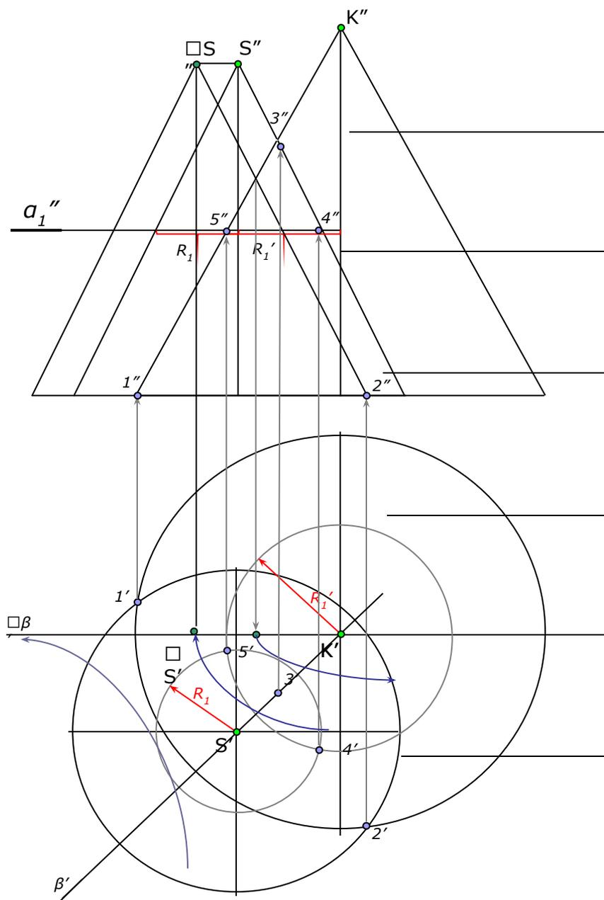
Проведя вспомогательные секущие горизонтально-проецирующие плоскости  $a_1 - a_n$ , получаем в сечении каждой поверхности окружность. Проекции двух окружностей на горизонтальной плоскости проекции пересекаются между собой в двух точках  $4'$  и  $5'$ , принадлежащих искомой линии пересечения. Фронтальные проекции этих точек строятся с помощью линий связи, они расположены в плоскости  $\Pi_2$  на следе секущей плоскости.
