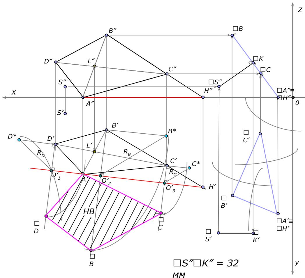
Двугранный угол измеряется линейным углом, составленным линиями пересечения граней двугранного угла с плоскостью, перпендикулярной к его ребру.
