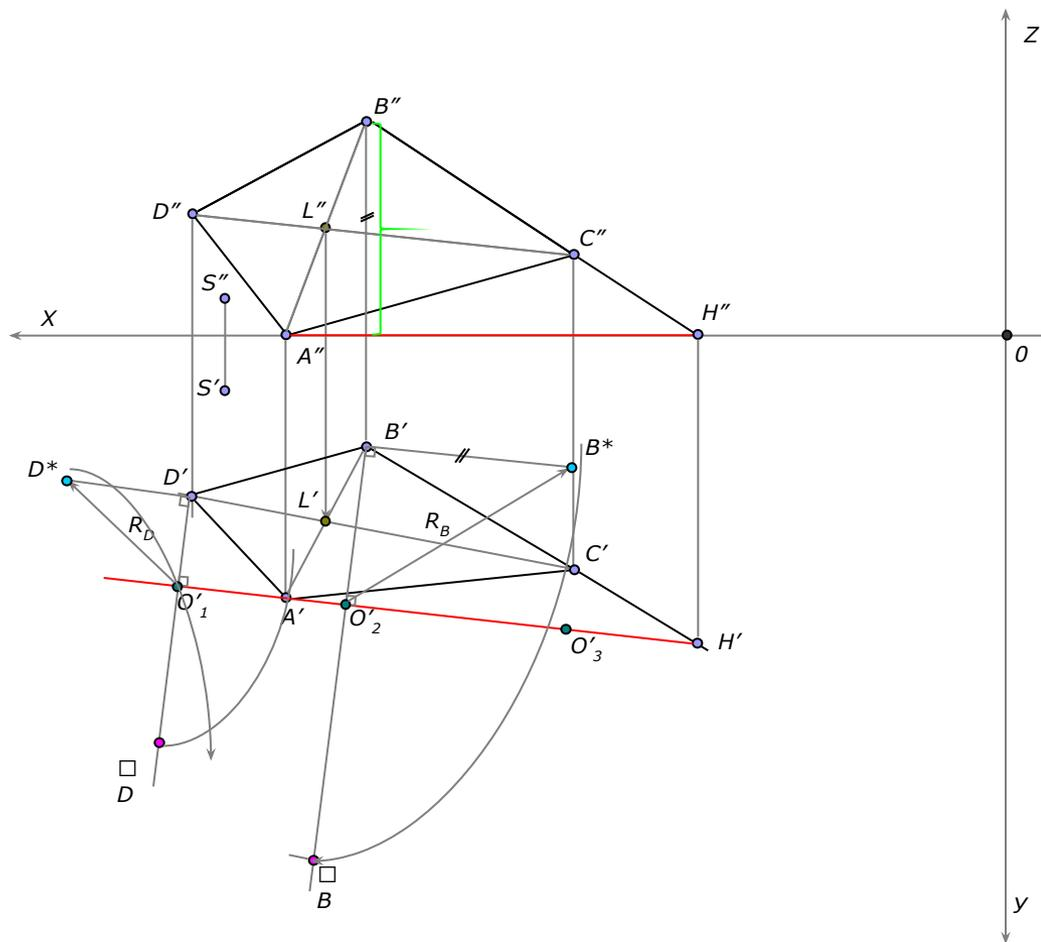
В горизонтальной плоскости проекции из точки  $B'$  опускаем перпендикуляр на ось вращения  $A'H'$ , на их пересечении образуем центр вращения (т.  $O'_2$ ) соответствующей точки  $B$ .
