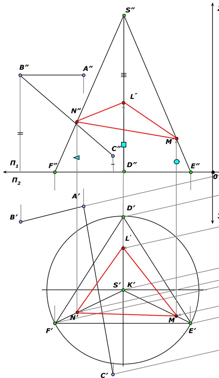
Линия сечения проецируется на плоскость проекции  $\Pi_4$  в виде отрезка прямой на следе этой плоскости. Имея проекцию сечения на дополнительной плоскости  $\Pi_4$  строят основные ее проекции.
