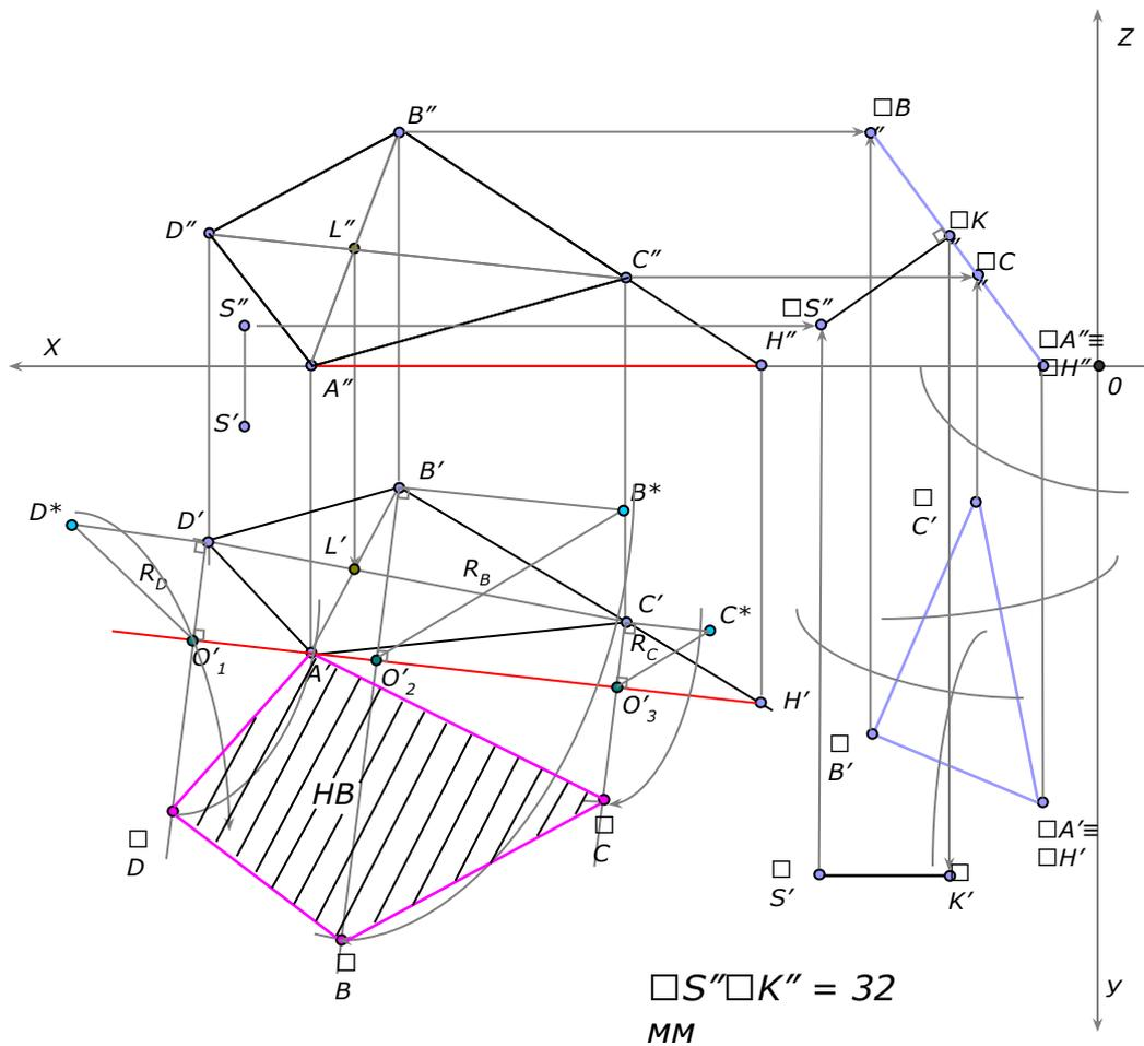
Для того чтобы линейный угол спроецировался на плоскость проекций в натуральную величину, надо новую плоскость проекций  $\Pi_5$  поставить перпендикулярно к ребру BC двугранного угла.
