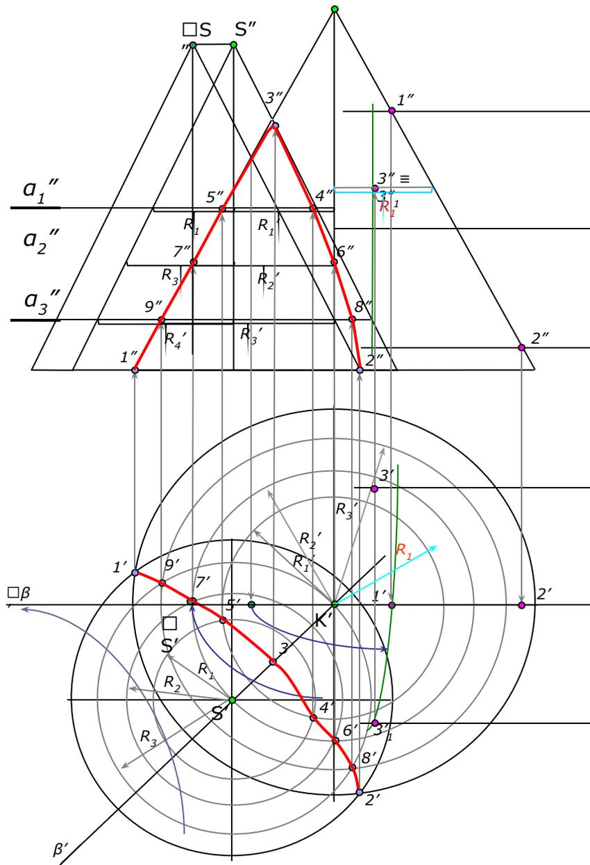
Из точки пересечения осей как из центра проводится сфера произвольного радиуса. Она пересекает обе поверхности по окружностям.
