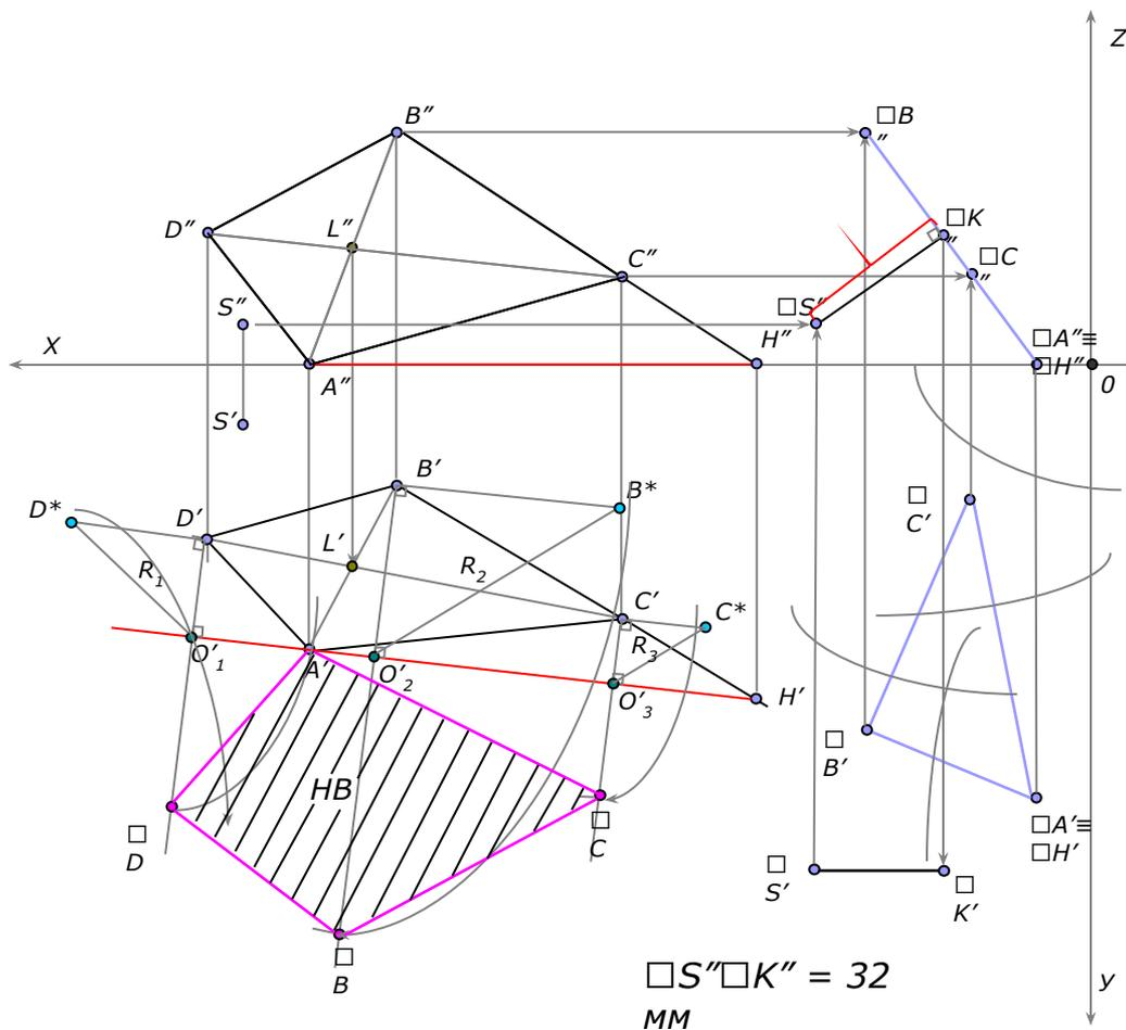
По перемещенной горизонтальной проекции  $\Delta \bar{A}'\bar{B}'\bar{C}'$  и его исходной фронтальной проекции строим новую фронтальную проекцию  $\Delta ABC$  и точки  $S$ . Определяем расстояние от  $t.S$  до заданной плоскости. Оно равно отрезку перпендикуляра  $SK$ , опущенного из  $t.S$  на плоскость  $a$  выродившуюся на новой фронтально-проецирующей плоскости проекций в прямую линию. Получив основание перпендикуляра  $SK$ , строим его горизонтальную проекцию на исходном чертеже задачи.
