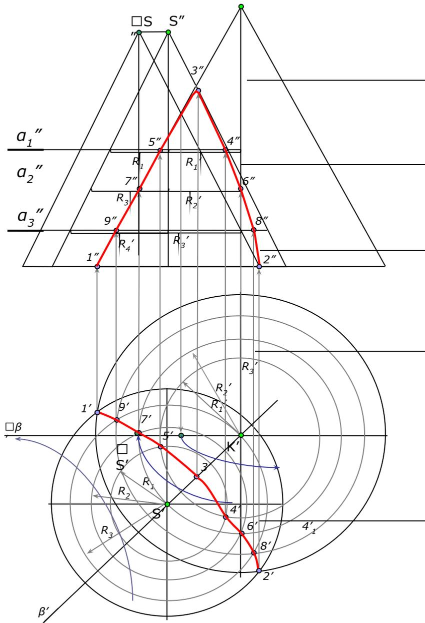
По точкам строится линия пересечения поверхностей вращения и устанавливается ее видимость в проекциях.
