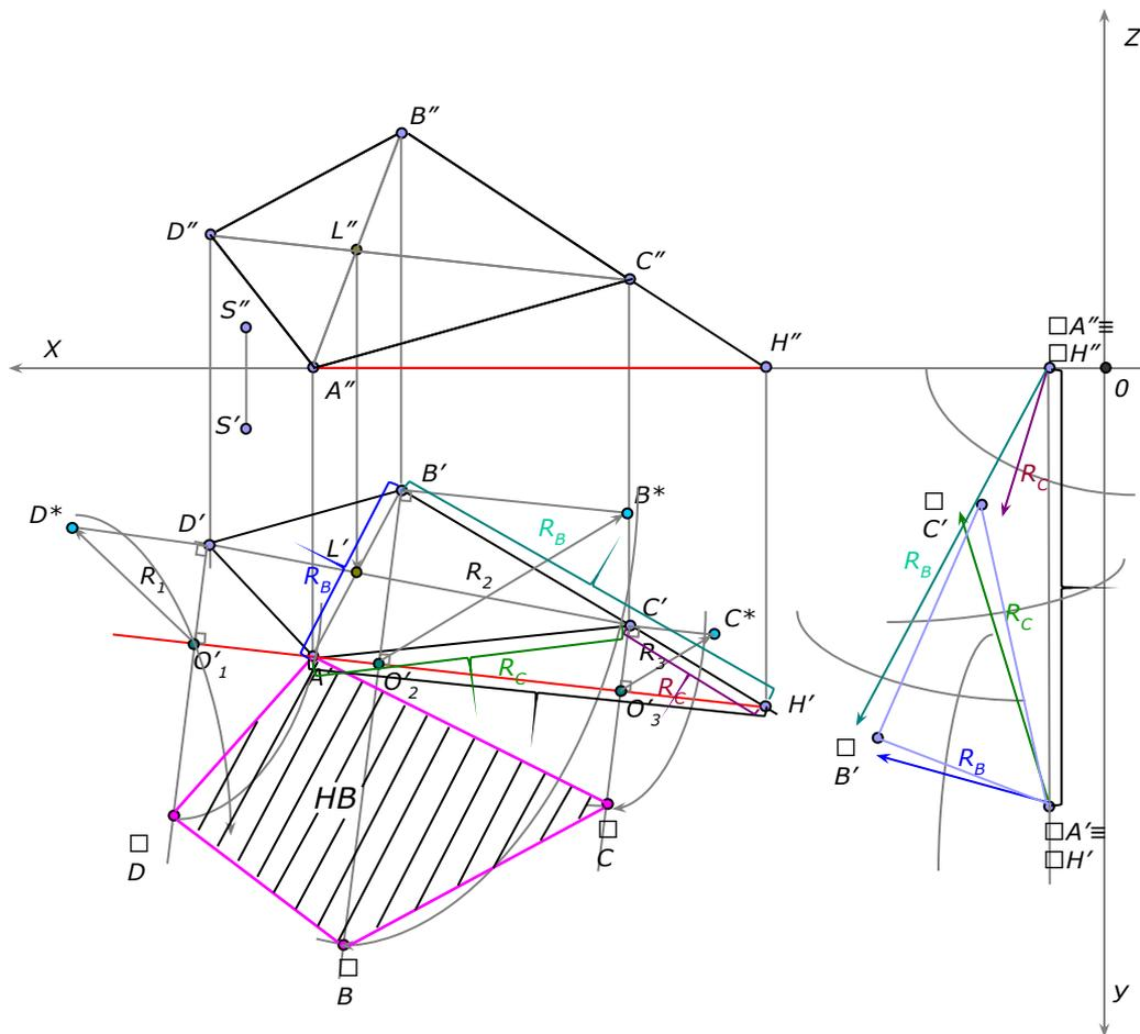
Приводим плоскость ABC в положение проецирующей плоскости, т.е. перпендикулярной плоскости проекции. Для получения фронтально-проецирующей плоскости необходимо горизонталь AN плоскости  $\alpha$  вместе с системой всех точек плоскости ( $\Delta ABC$ ) поставить в положение, перпендикулярное фронтальной плоскости проекций.
