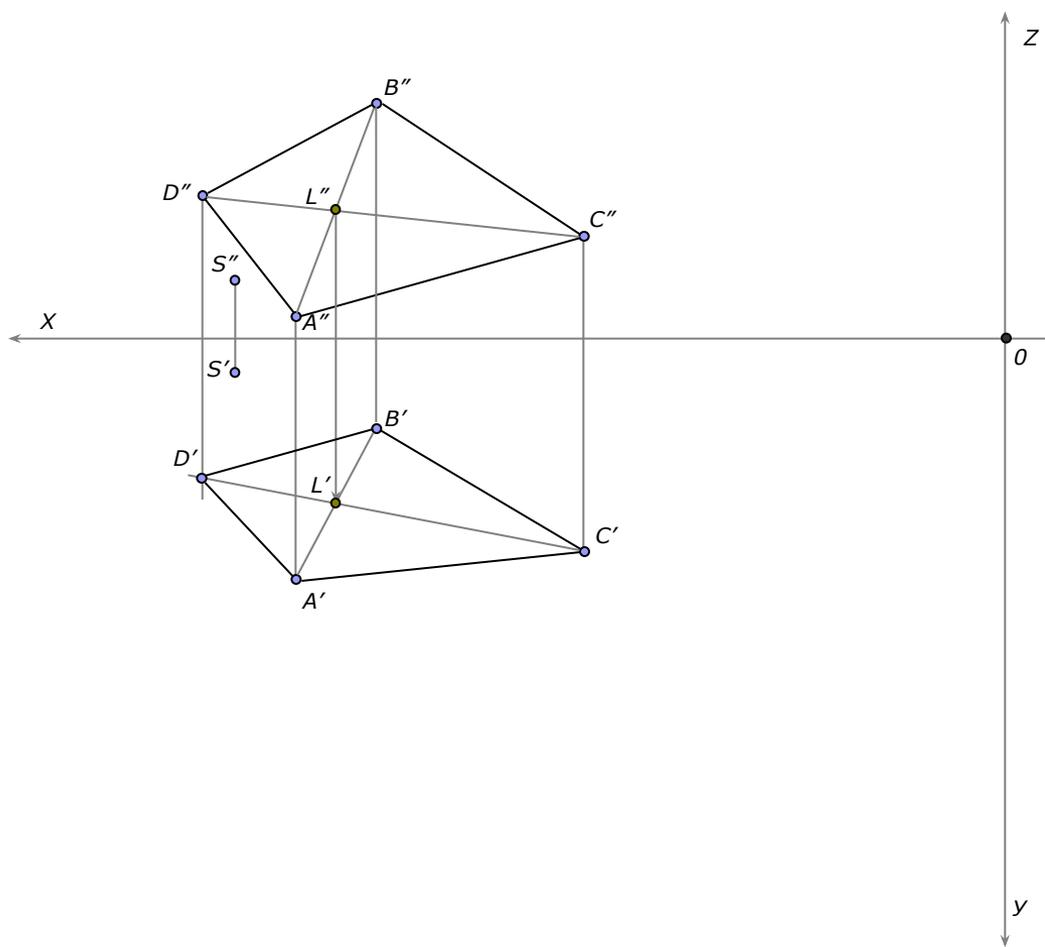
Согласно индивидуального задания отмечаем по координатам точки  $S, A, B, C$  и  $D''$ , недостающую координату  $t$ .  $D'$  - определяем построением. Соединяем точки отрезками, образуем плоскость основания пирамиды  $ABCD$ .
