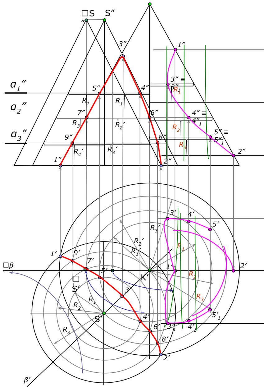
Построив достаточное число точек для построения линий пересечения поверхностей и определив ее видимость в проекциях, обводим линию пересечения поверхностей.
