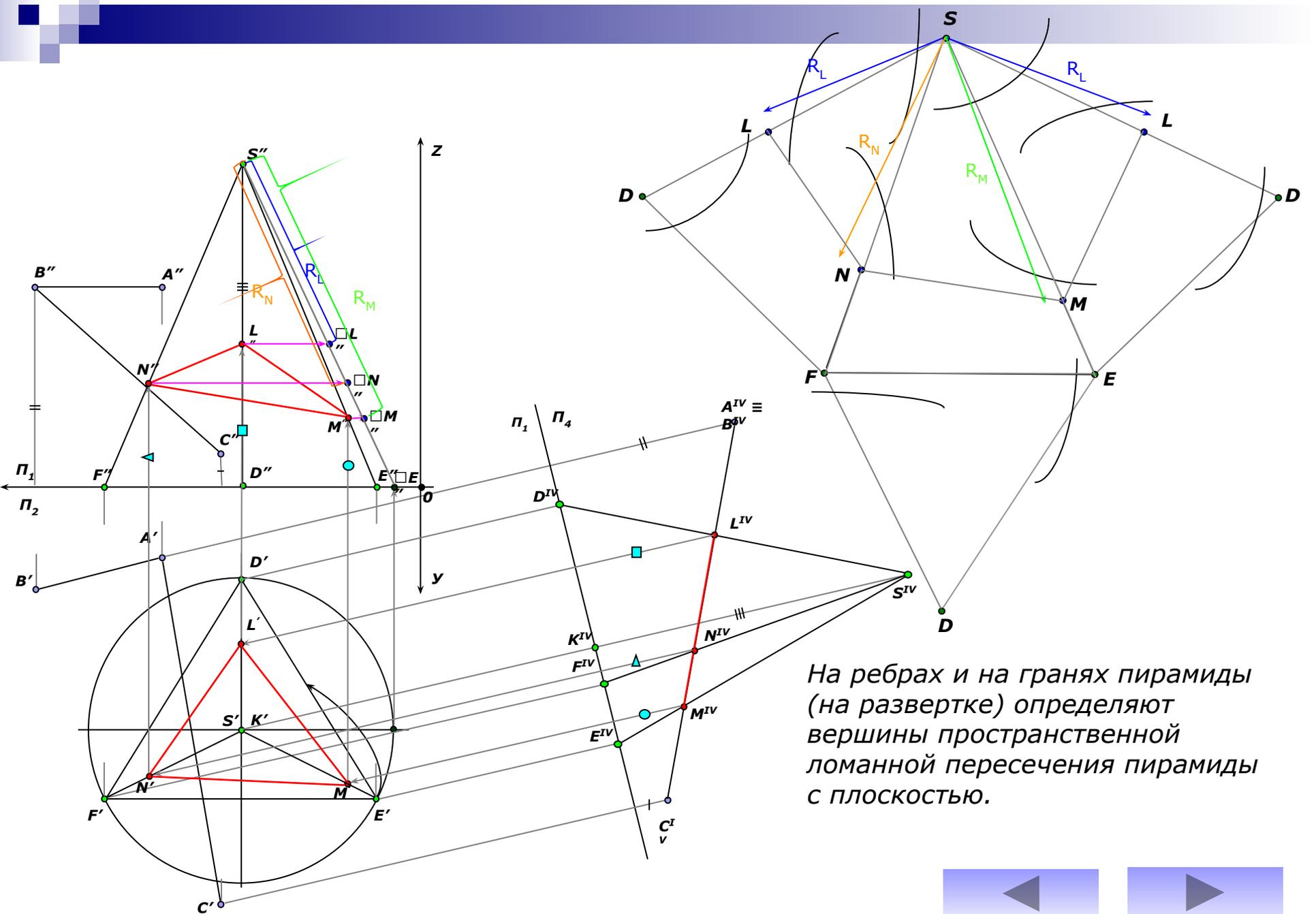
На ребрах и на гранях пирамиды (на развертке) определяют вершины пространственной ломанной пересечения пирамиды с плоскостью.
