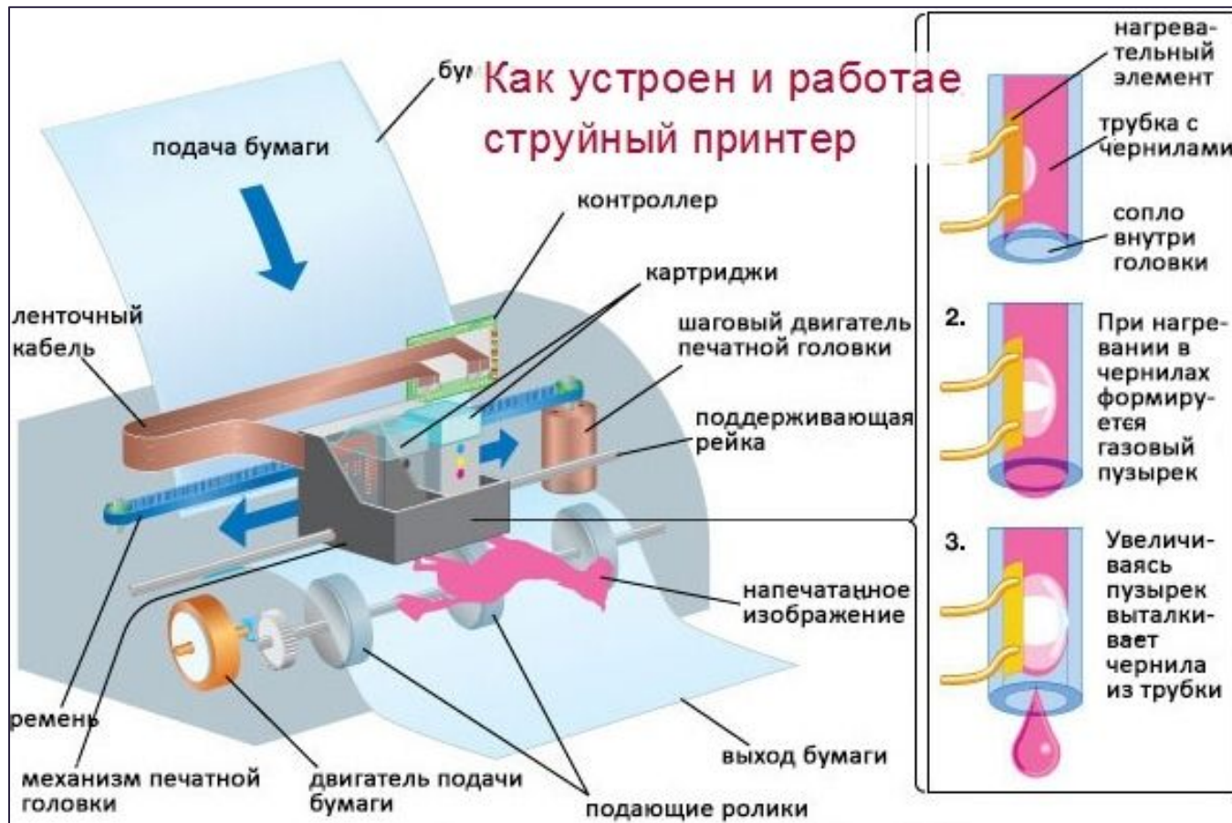
Схема работы струйного принтера
