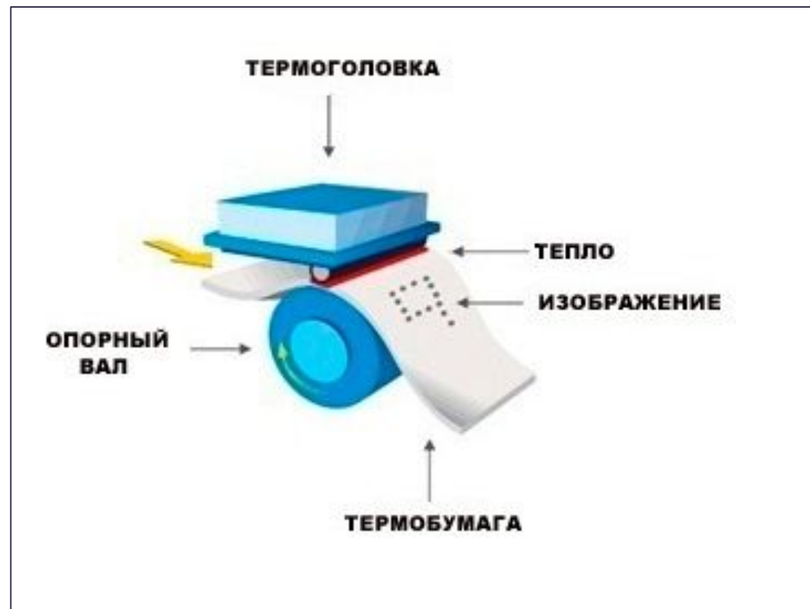
Схема работы термопринтера
