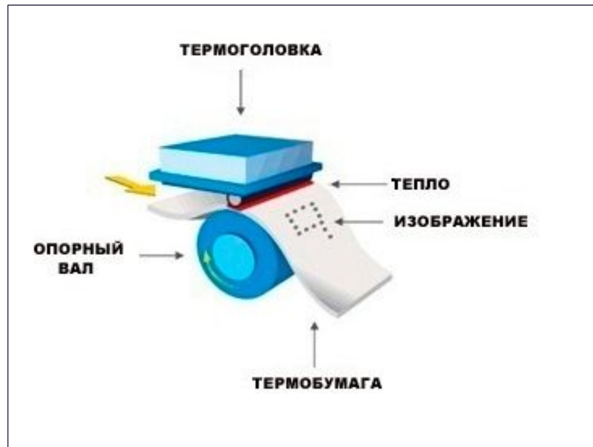
Схема работы термопринтера
