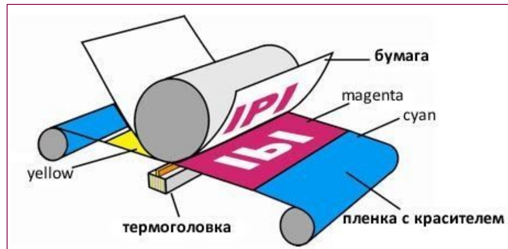
Схема работы сублимационного принтера
