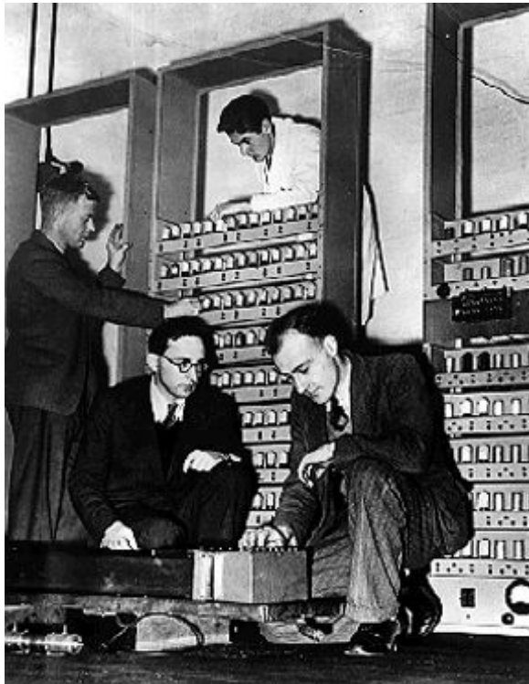
Морис Уилкс у машины EDSAC. 3000 ламп, ОЗУ 512 слов
