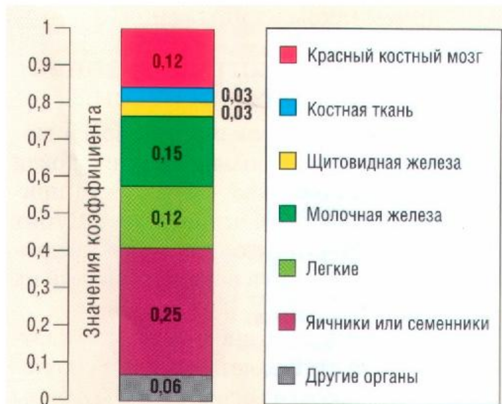
Рис. 1. Коэффициенты радиационного риска для разных органов человека при равномерном облучении (1,00 — организм в целом)
