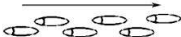
Правило передвижения в зоне «растекания высоковольтного напряжения».
