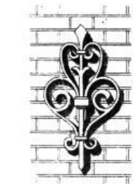
ФИГ. 9 БАЛОЧНАЯ СКОБА 3 я ЭТАЖА
