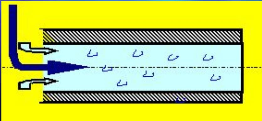
Струйка краски распалась на отдельные вихри. Слои жидкости перемешиваются в поперечном направлении. **Турбулентное движение** (от латинского turbulentus – хаотический, беспорядочный)
