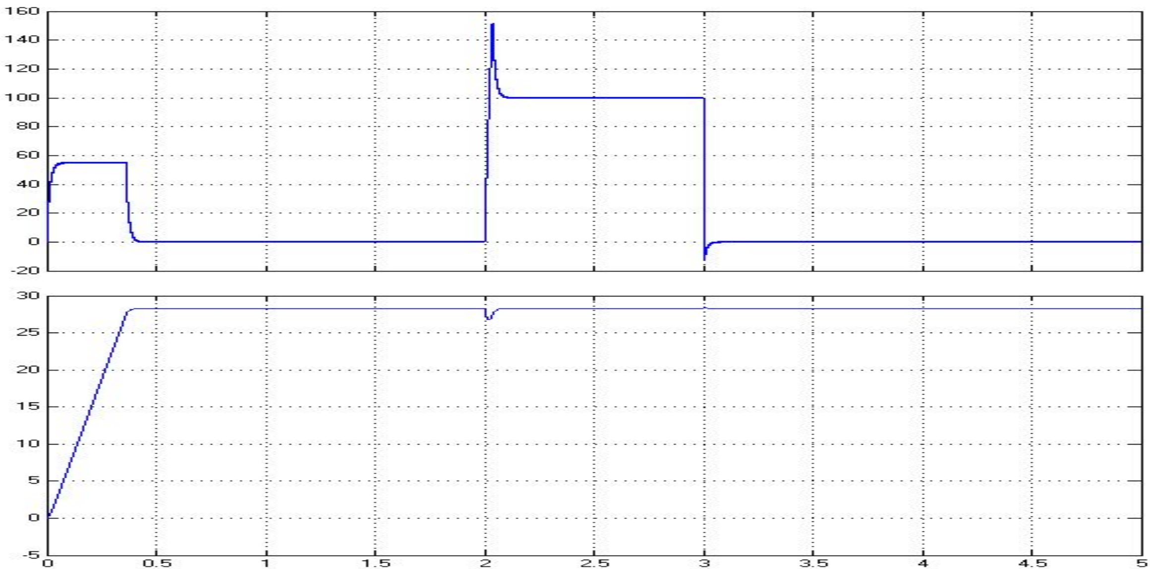
Переходные процессы тока и скорости в релейной системе при уменьшении T_M в 2 раза
