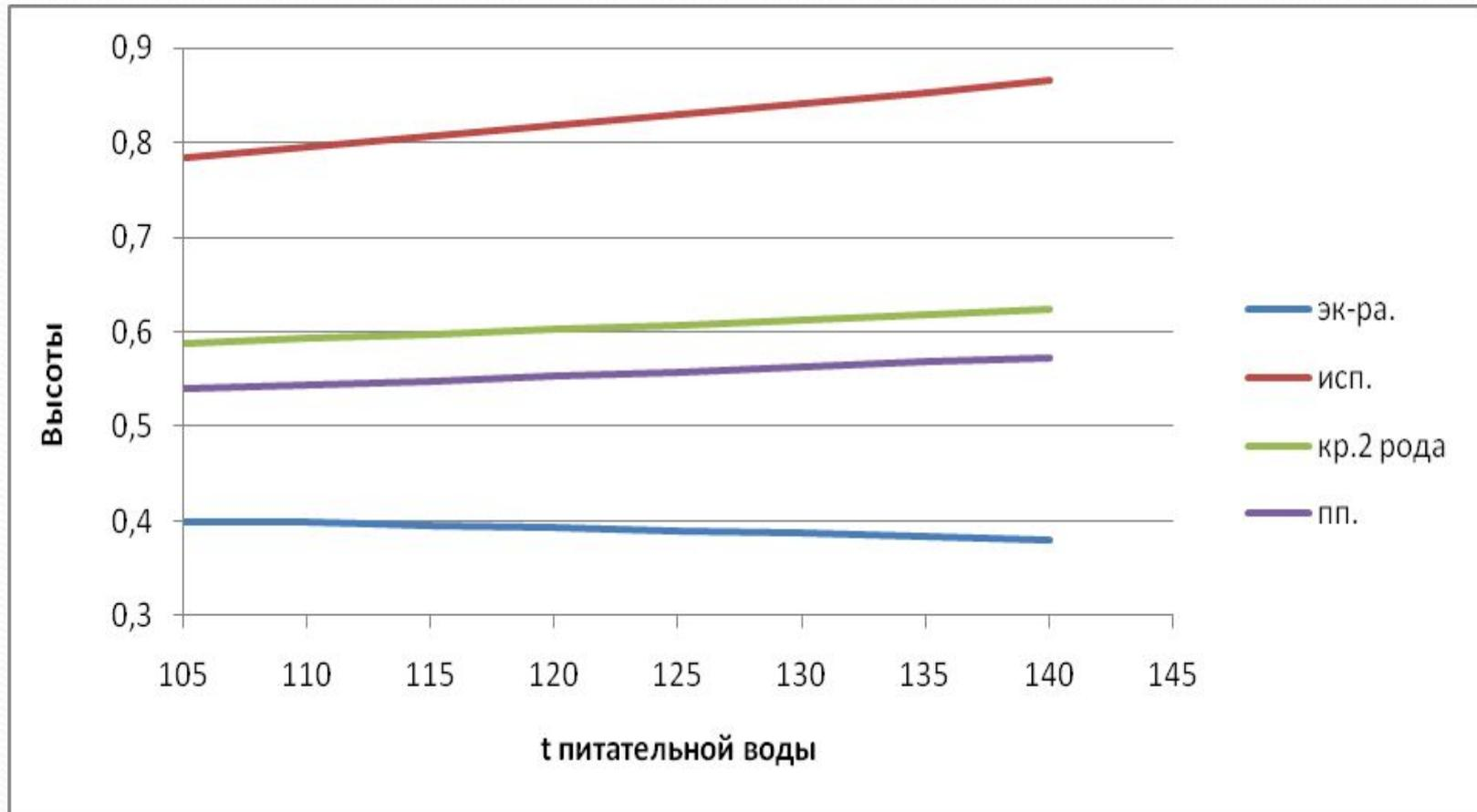
**Зависимость высоты и диаметра трубной системы от температуры питательной воды.**
