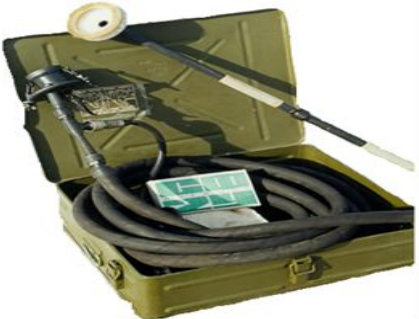
**Состав комплекта ДК-4:** укладочный ящик (или две брезентовые сумки); газожидкостный прибор; порошок СФ-2У (пачка); полиэтиленовая банка для ГК; ЗИП и крепежные детали.
