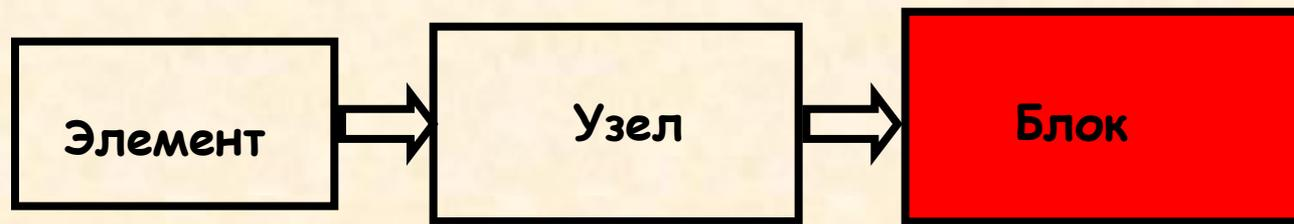
**Блок** - функциональный компонент ЭВМ, состоящий из элементов и узлов и выполняющий операции над машинными словами или управляющий такими операциями (пример: блок регистров).
